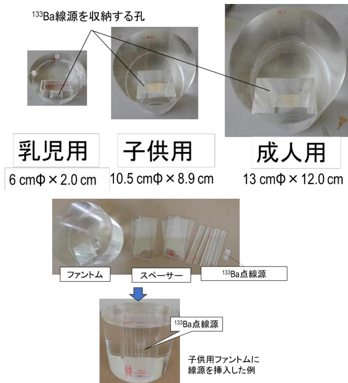
図 4-2-2 甲状腺モニタ校正に使用した簡易物理ファントム (上) とファントムへの ^{133}\text{Ba} 点線源挿入の様子 (下)
