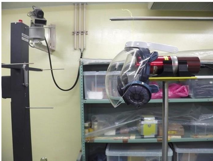
図 3-7 \beta 線のマスク遮へい実験の様子 線源： ^{90}\text{Sr} - ^{90}\text{Y} (公称 74 MBq, 平坦化フィルタ使用せず), \beta 線スペクトロメータの前面に全面マスク E と防護面 F の組み合わせを設置
