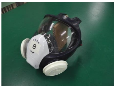
B: 全面マスク バイザー厚さ: 2.35 mm (Gと組み合わせて使用)
