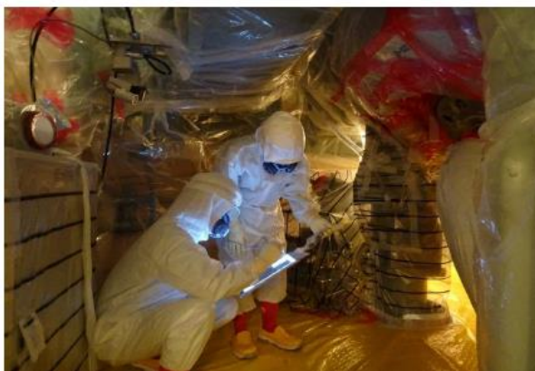
図 2-3 蒸気発生器マンホール開放後の作業場周辺の \gamma 線スペクトル測定の様子
