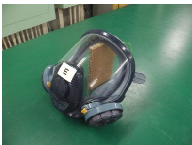
E: 全面マスク バイザー厚さ: 1.5 mm (Fと組み合わせて使用)
