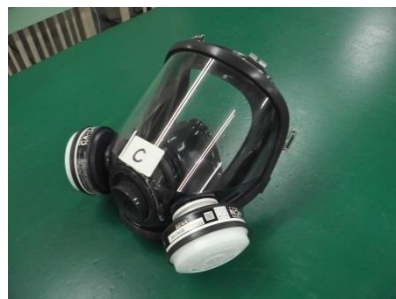
C: 全面マスク バイザー厚さ: 1.5 mm (緊急作業時に使用されていたもので現在は使用されていない)
