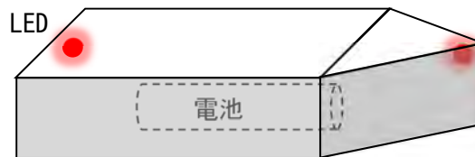
図- 7.4 漂流物模型の構造
