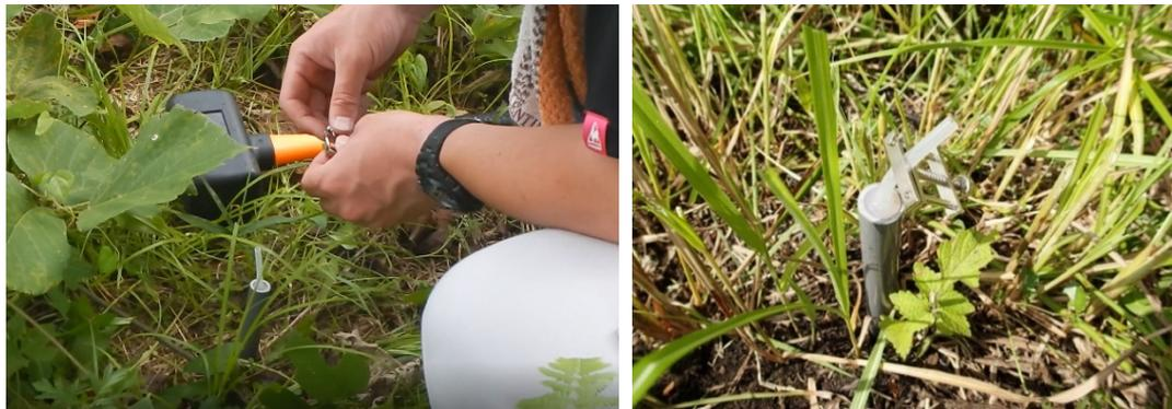
図 A-1-5 採気孔への塩ビ管とガス取り出し用のゴム栓の設置作業 (左) と設置状態 (右)
