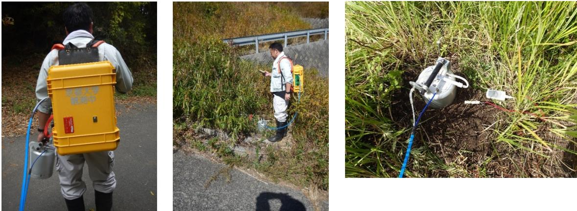
図 A-1-1 土壌 CO<sub>2</sub> フラックス観測装置（左の写真）と観測の様子（中央の写真）およびチャンバーの設置状況（右の写真，デジタル温度計による土壌温度も計測中）
