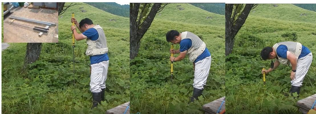
図 A-1-3 ボーリングバーによるさく孔作業の様子。(左上の写真) ボーリングバー、実際に使用したものは掘削長 865mm・掘削径 16mm の標準タイプ)、(3枚の連続写真)
