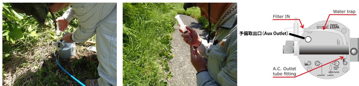
図 A-1-2 土壌 CO<sub>2</sub> フラックスメーターのチャンバーからの土壌ガス試料の採取作業の様子 (写真) とチャンバーを上から見た模式図
