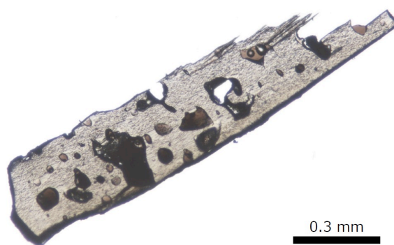
図 2-1-45 メルト包有物を含む斜方輝石斑晶
