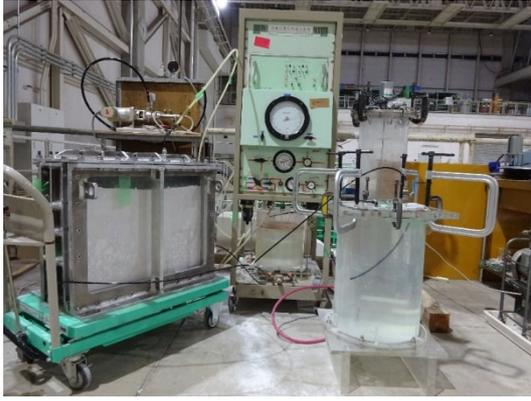
写真 3-8 浸透圧による圧密
