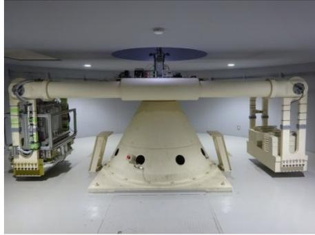
写真 3-1 遠心載荷実験装置
