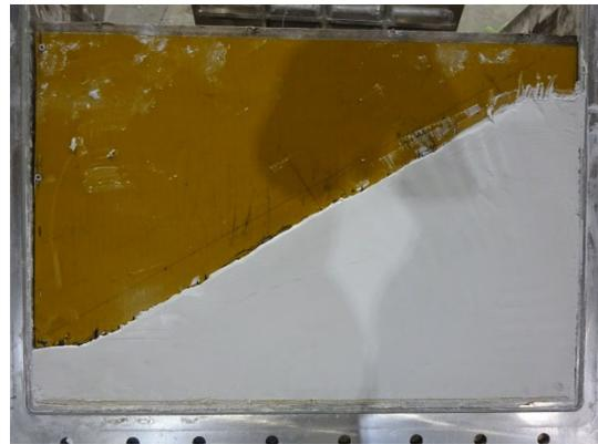
写真 3-13 斜面模型地盤の成型
