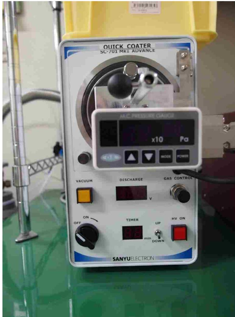
图 2.1.3 薄膜成膜装置外觀
