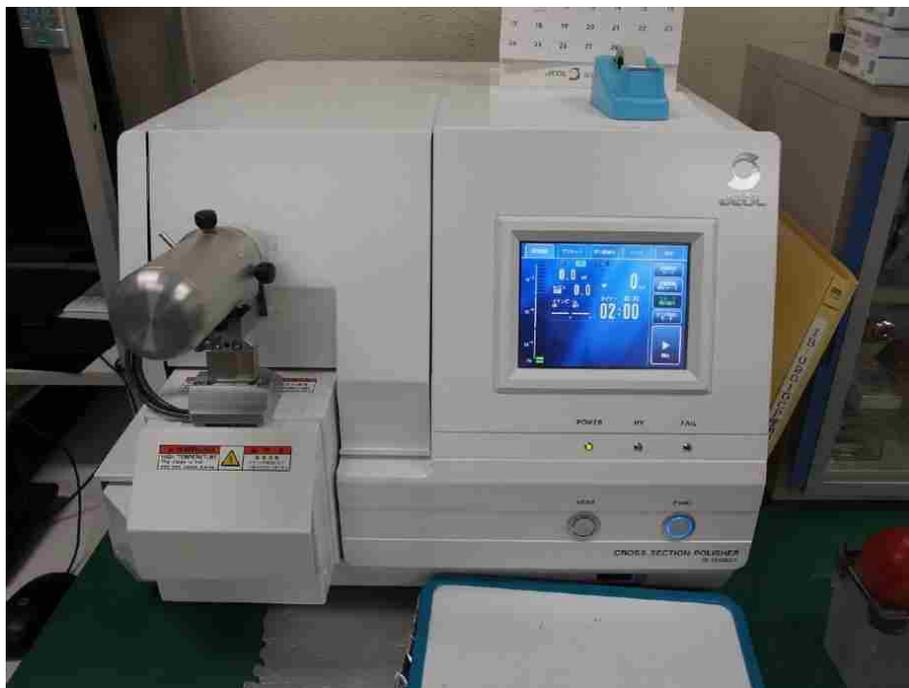
図 2.1.2 断面試料作成装置外観
