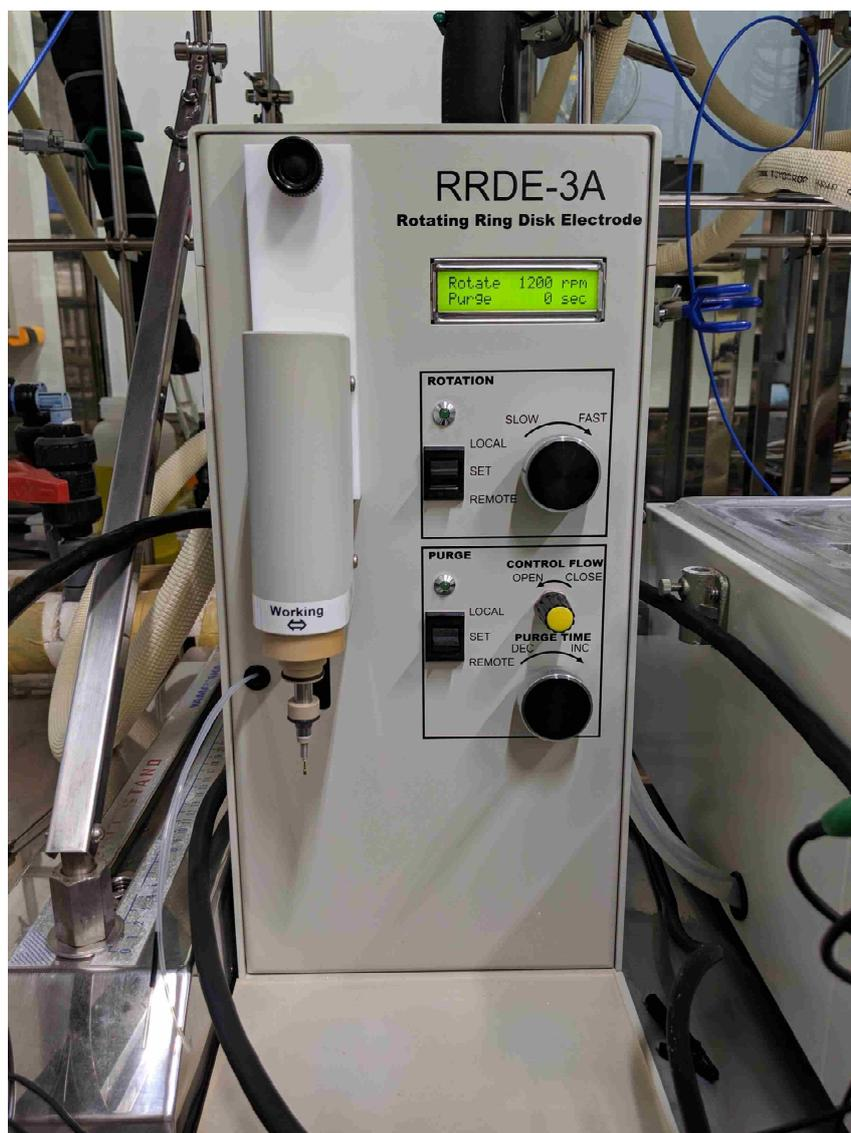
図 3.1.4 回転電極装置外観
