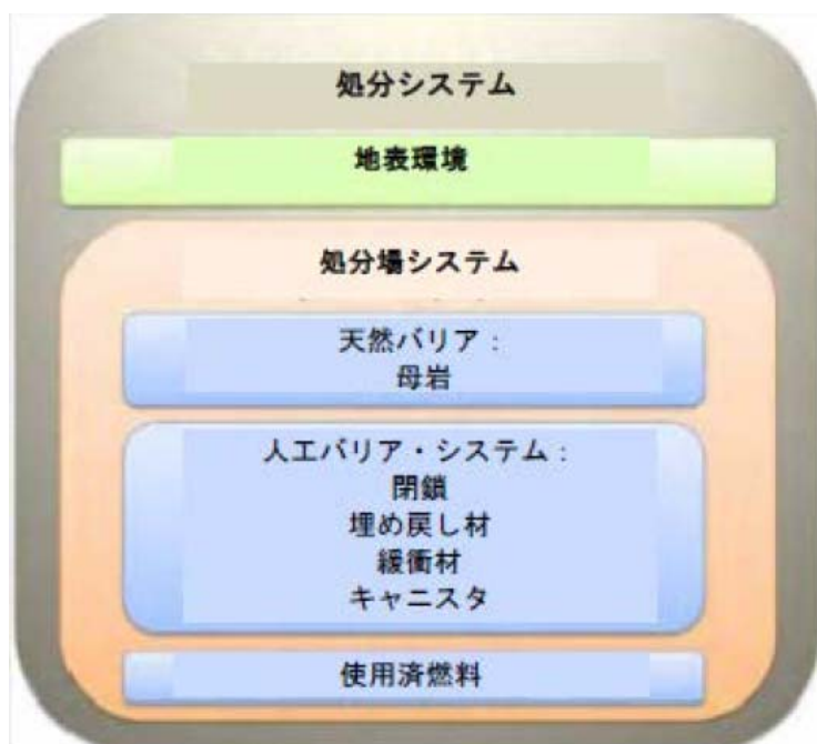
図 2.2-3 処分システムの構成要素。安全機能は、天然バリア（母岩）及び人工バリア・システムの構成要素（閉鎖材、埋戻し材、緩衝材及びキャニスタ）に割り当てられている。
