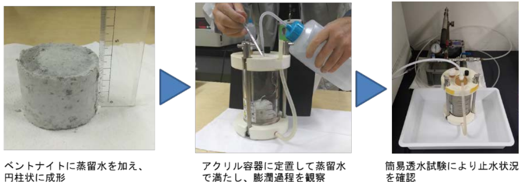
図 1.3-44 簡易室内試験の手順
