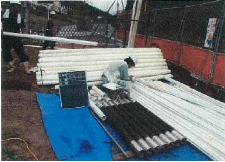
図 4.2-14 回収された PIEZO システム (DH-2 号孔)
