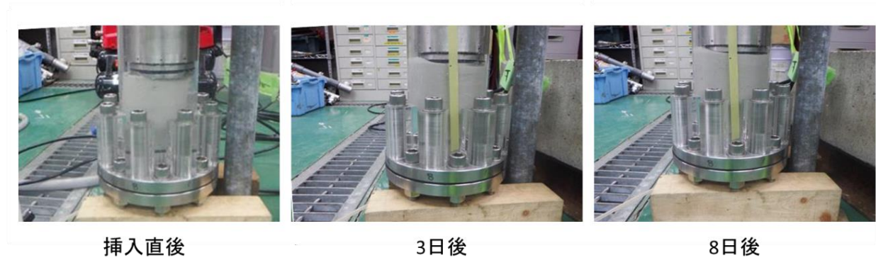
図 4.3-21 閉塞材定置後の膨潤状況
