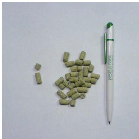
図 4.2-5 ベントナイトペレットの例 (CEBOGEL pellets) 21) (Courtesy of Swedish Nuclear Fuel and Waste Management Co)
