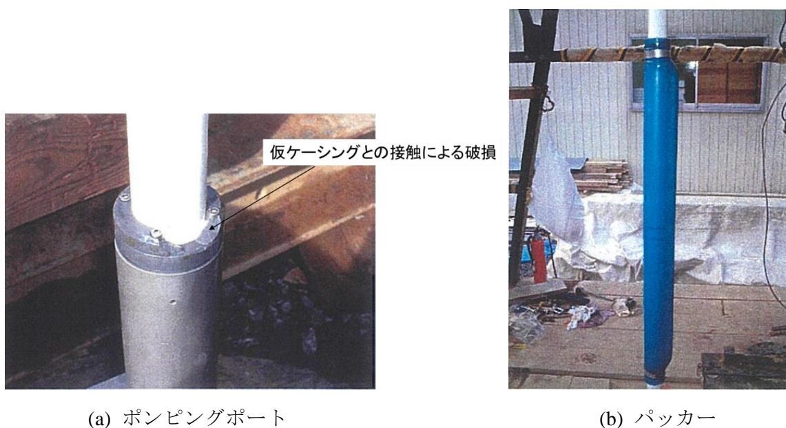
図 4.2-12 回収された MP システム（MIU-2 号孔）
