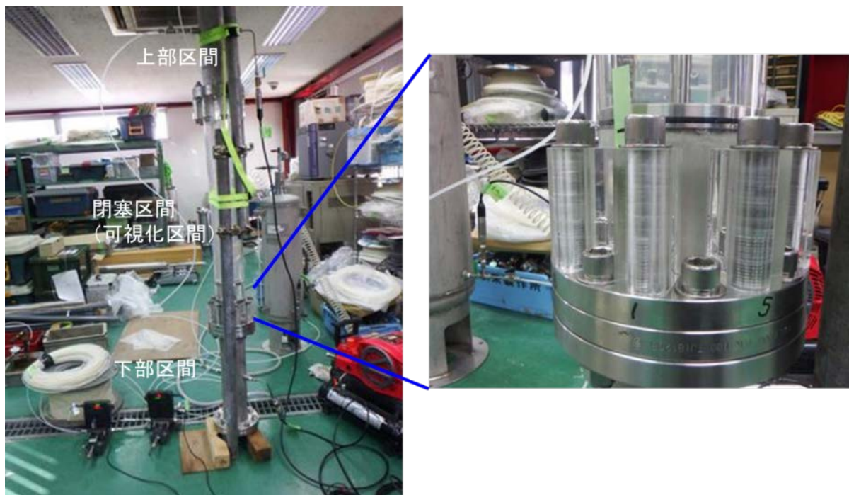
図 1.3-49 室内模擬透水試験装置
