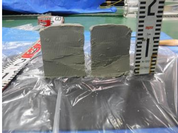
図 4.3-14 試験終了後の閉塞材の内部（粉末ベントナイト 100%）
