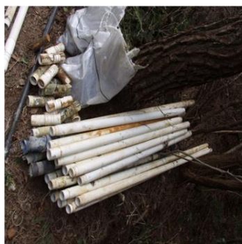
回収されたMP観測装置(0.0-59.5M) MPケーシング、レギュラーカップリング、ロケーションカラー、メジャメントカップリング
