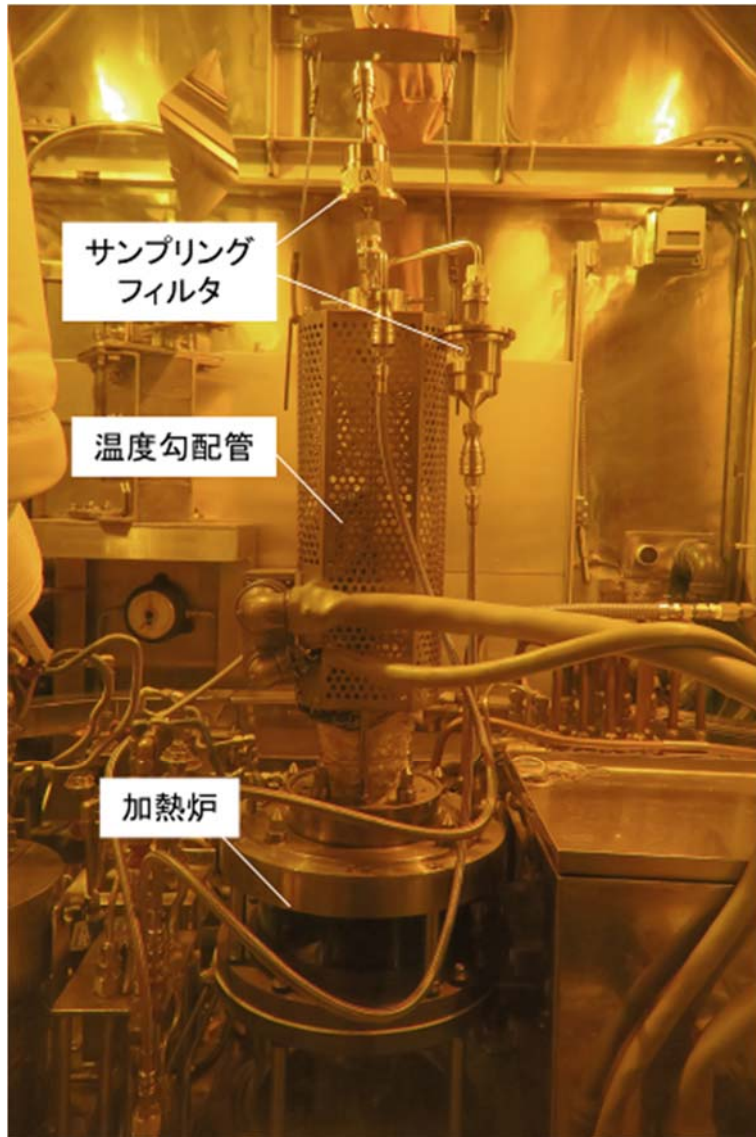
図 2.2.1.2 FP 放出移行試験装置外観写真
