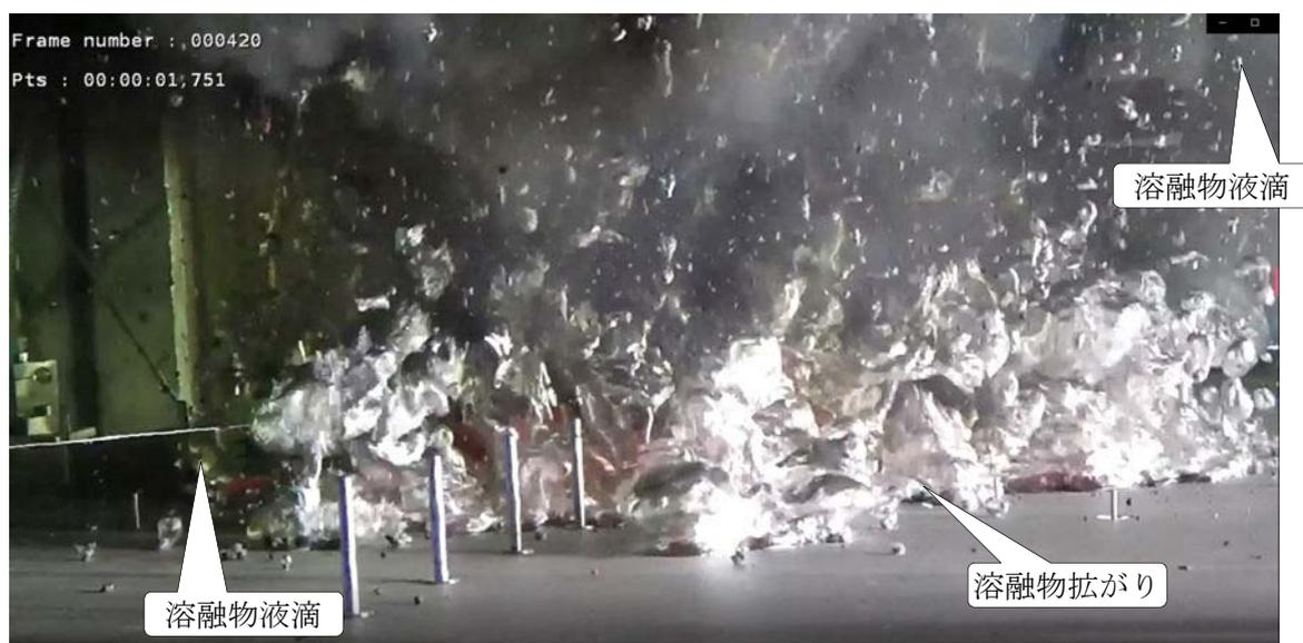
図 3.17 E9 実験の溶融物落下状況
