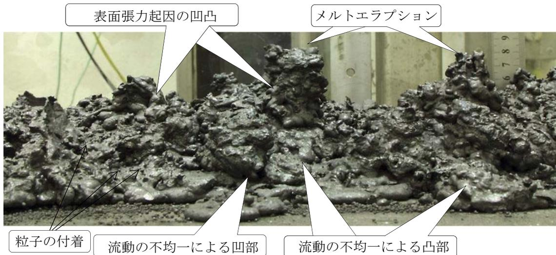
図 3.43 固化デブリの拡大写真 (E11 実験の例)
