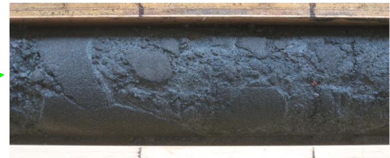
上盤側の凝灰質砂岩が角礫状(砂質の基質を伴う)
