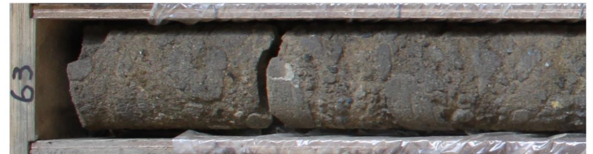
上盤側の凝灰質砂岩が角礫状 ※2019年撮影
