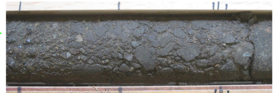
上盤側の凝灰質砂岩が角礫状(シルト質の基質を伴う)
