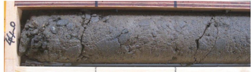
上盤側の凝灰質砂岩が角礫状(シルト質の基質を伴う)
