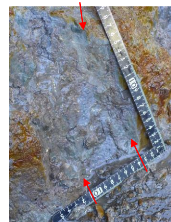
T6(2)トレンチ南面 ⑥破砕部の条線
