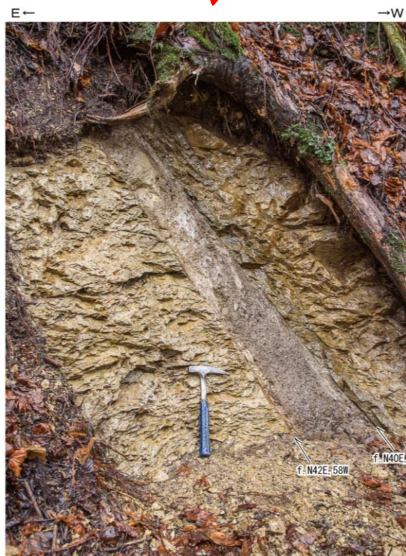
Loc. u320-2 東通村老部川支流 蒲野沢層泥岩中の断層。2条の断層面に挟まれる幅20~30cmの間は破碎部となっている。 破碎部内には泥岩がブロック~レンズ状に取り込まれる。
