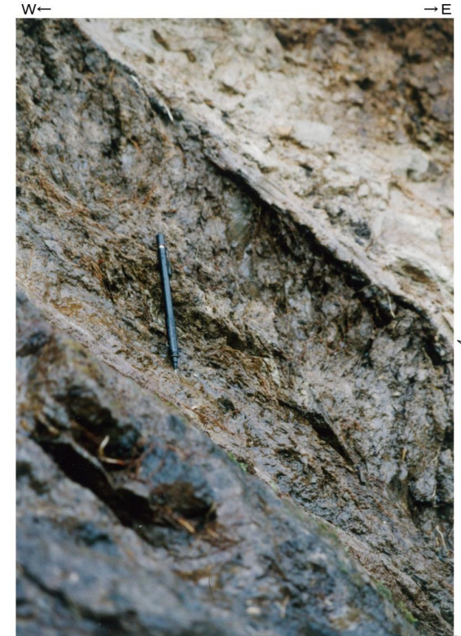
同左拡大 断層面沿いには幅数mmの軟質粘土がみられ、2条の断層面に挟まれる幅約30cmの間にはセピオライトが挟在する。
