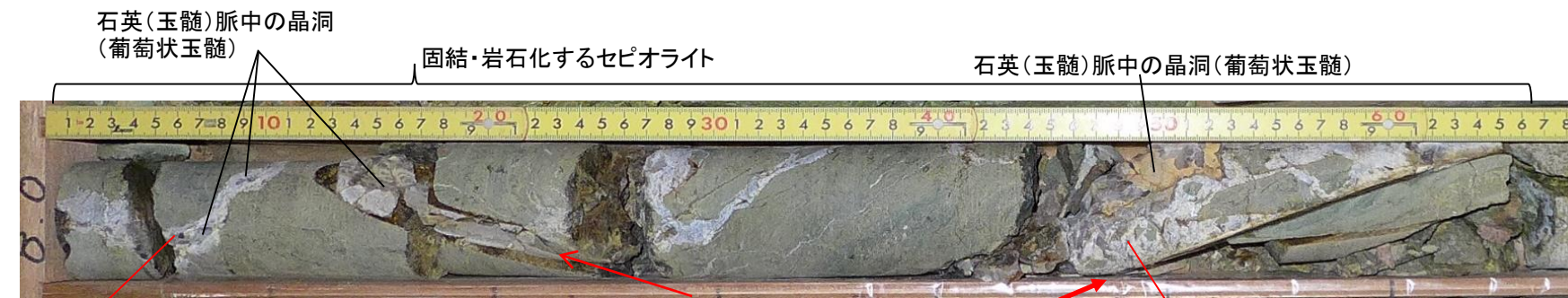
石英(玉髓)脈中の晶洞(葡萄状玉髓) 固結・岩石化するセピオライト 石英(玉髓)脈中の晶洞(葡萄状玉髓) 不規則な形状に晶出した石英(玉髓)脈 せん断面と平行な石英(玉髓)脈 断層面(下盤側) 不規則な形状に晶出した石英(玉髓)脈 F-4断層: K-1孔深度8.00~8.68mコア 拡大写真②(平成29年撮影) ※コアが回転し方向が様々な状態のため、断層面の方向との関係が明瞭ではない。
