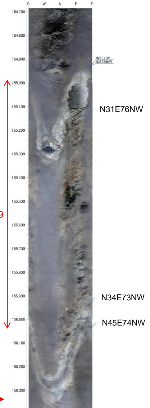
F-9断層破碎部は非固結 (細片状, 粘土状(パリゴルスカイト化))
