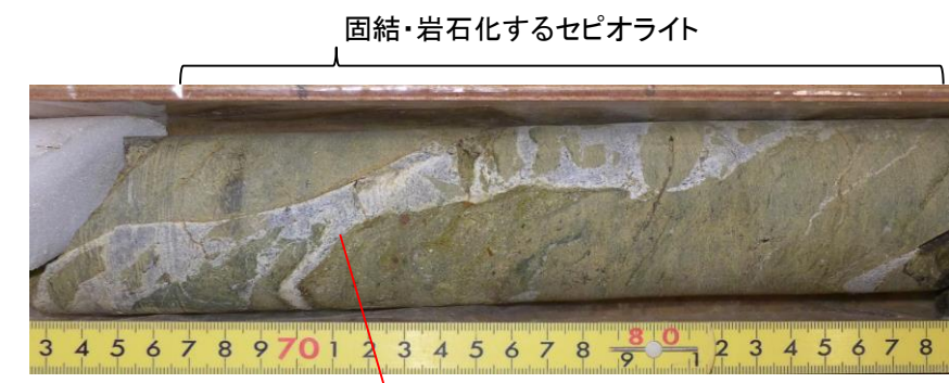
固結・岩石化するセピオライト F-4断層: K-1孔深度7.63~7.88mコア 拡大写真①(平成29年撮影)
