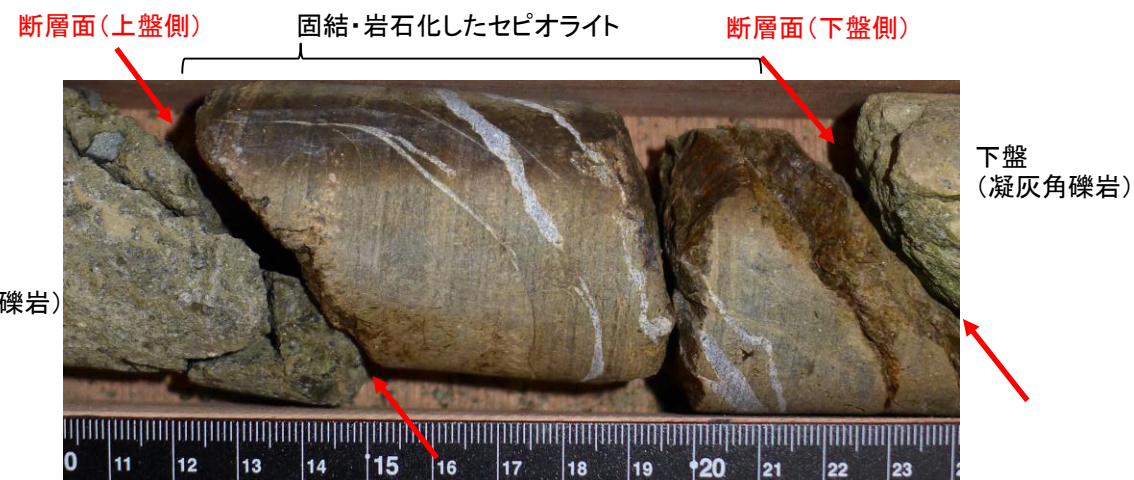
断層面(上盤側) 固結・岩石化したセピオライト 断層面(下盤側) 上盤(凝灰角礫岩) 下盤(凝灰角礫岩) 断層面と概ね平行な石英(玉髓)脈 H-3(F-3)断層: B-2e孔, 深度40.50~20.64mコア写真(平成29年撮影)
