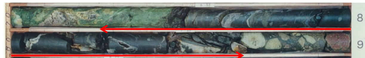
F-4断層 K-1孔コア写真: 深度7~9m(平成7年撮影)
