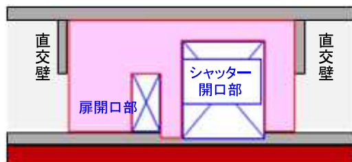
建家内開口部周辺の補強のイメージ図(建家内断面図)
