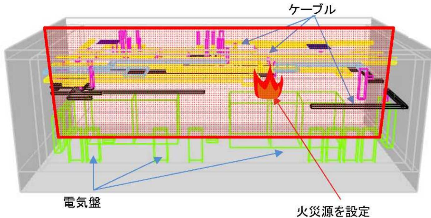
図 4.1-1 火災伝播解析モデルの例
