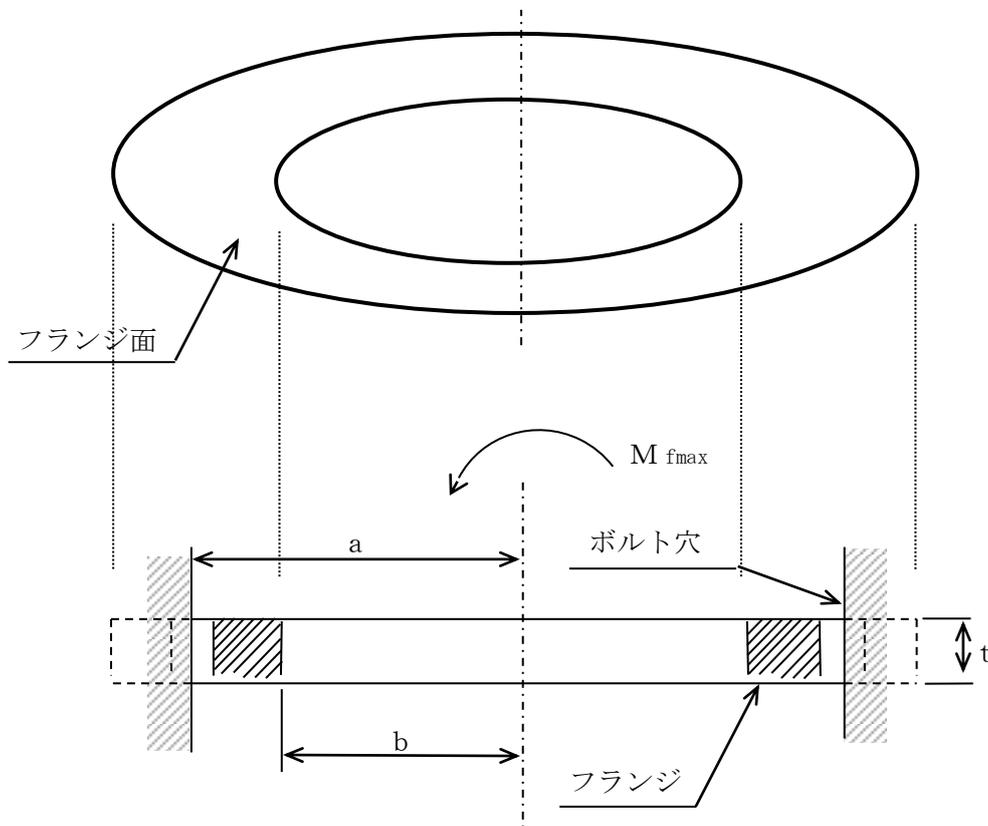
図 4-3 フランジ断面の計算モデル
