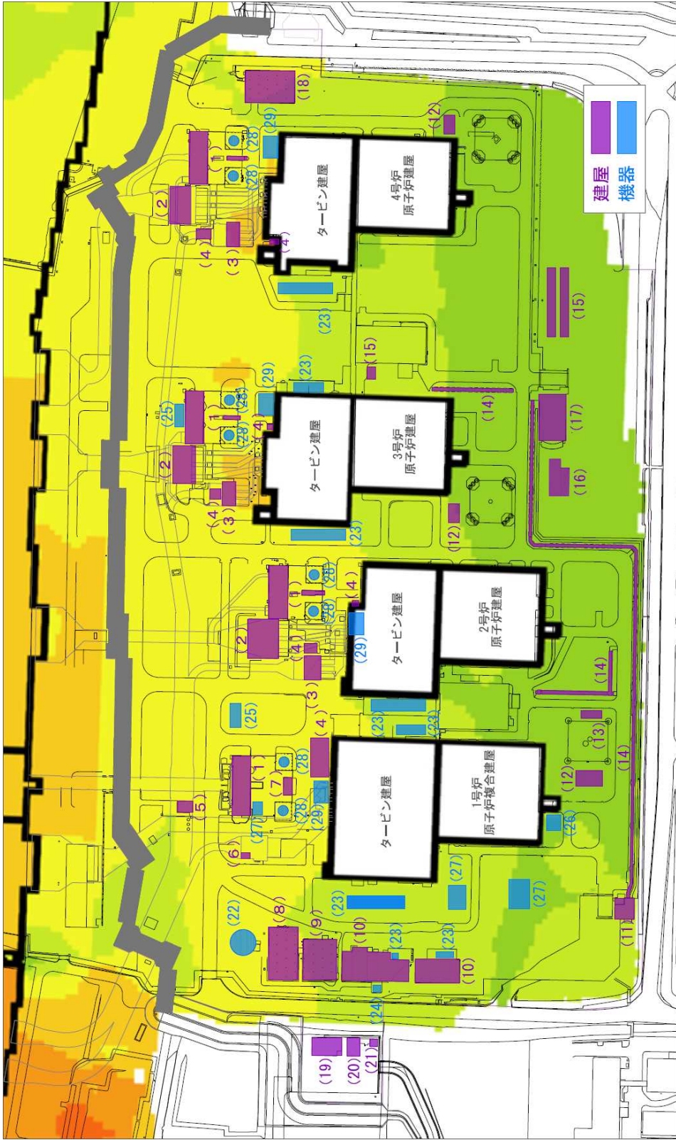
図 4.2-8-4-2 漂流物調査結果 (発電所構内荒浜側防潮堤内敷地詳細)
