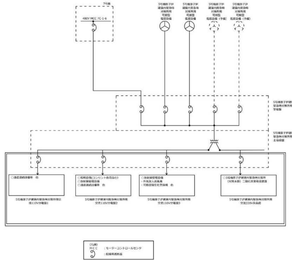
図 3-3 緊急時対策所単線結線図
