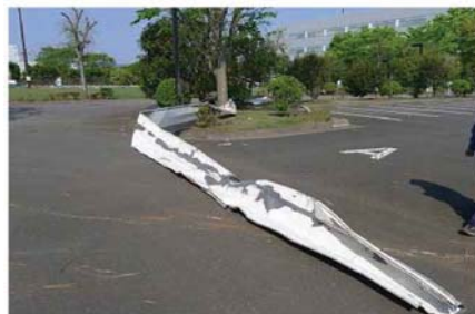
飛散した飛来物（鋼板製屋根材）
