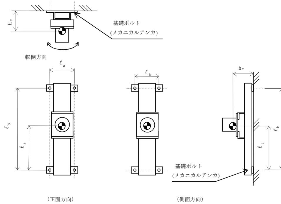
【残留熱除去系熱交換器入口冷却水流量（P21-FT-010C）の耐震性についての計算結果】
