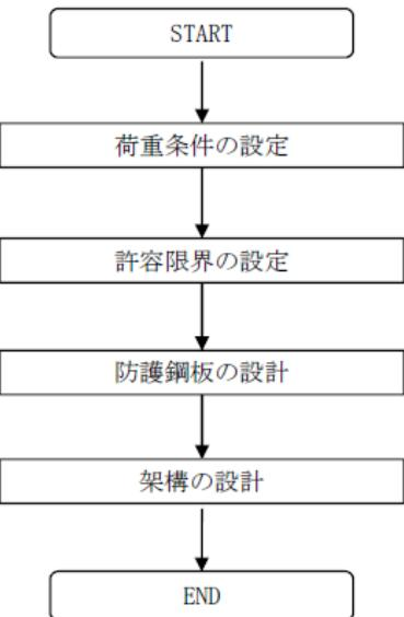
図 3-3 竜巻防護鋼製フードの設計フロー
