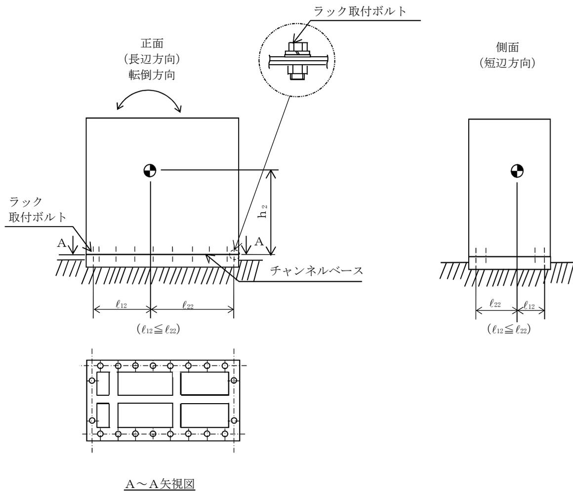
【原子炉圧力 (B21-PT-007C) の耐震性についての計算結果】
