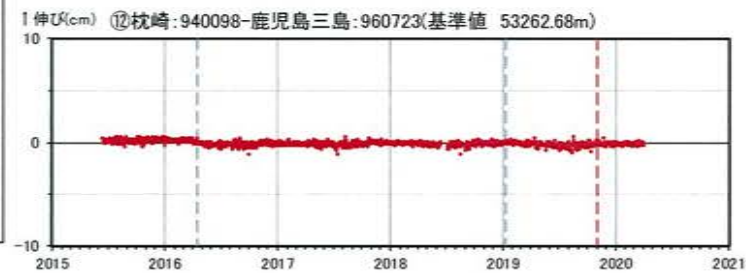
鬼界 GNSS連続観測による基線長変化(2015年06月11日～2020年03月31日)
