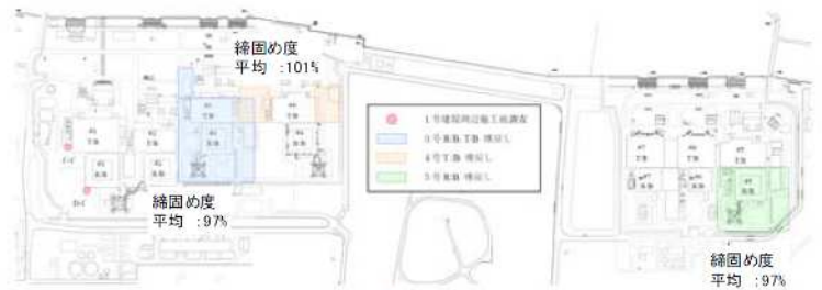
埋戻土の締固め度 (建屋周辺)
