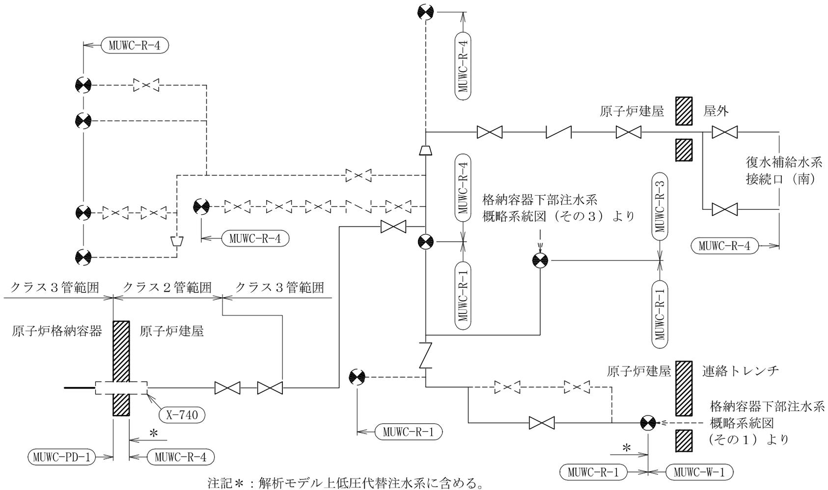
格納容器下部注水系概略系統図 (その2)
