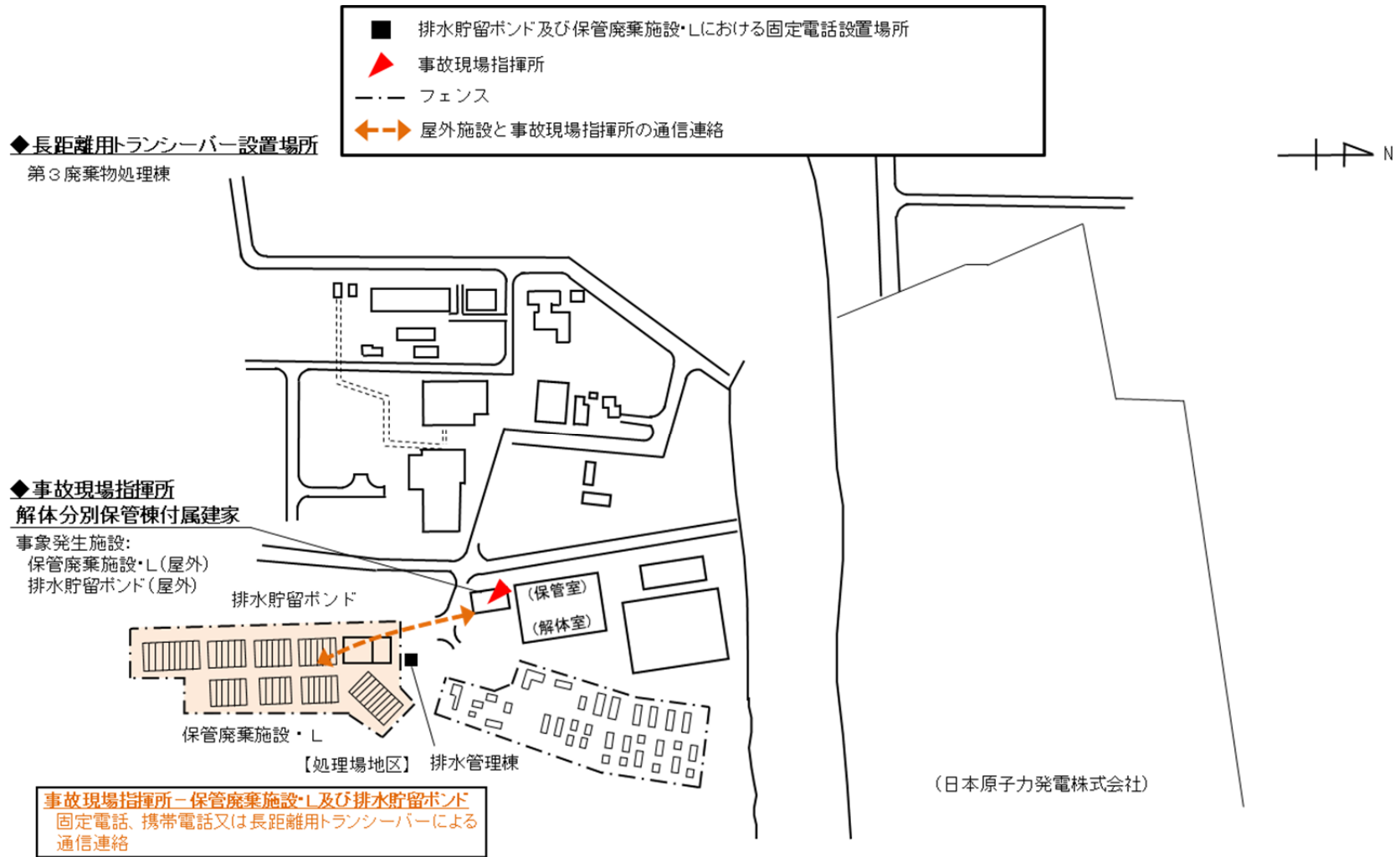
図-2.1 保管廃棄施設・L及び排水貯留ポンドの通信連絡設備の配置図
