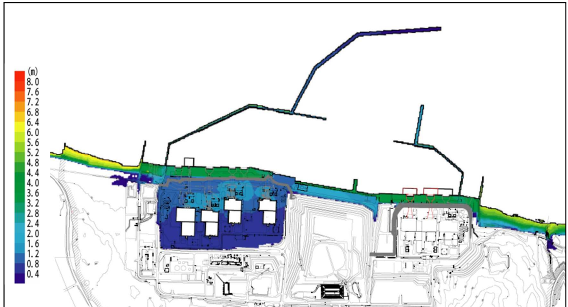
図 4.7-4 基準津波による荒浜側防潮堤内敷地の最大浸水深分布 (「V-1-1-3-2-3 入力津波の設定」図 3-3(1)を抜粋)
