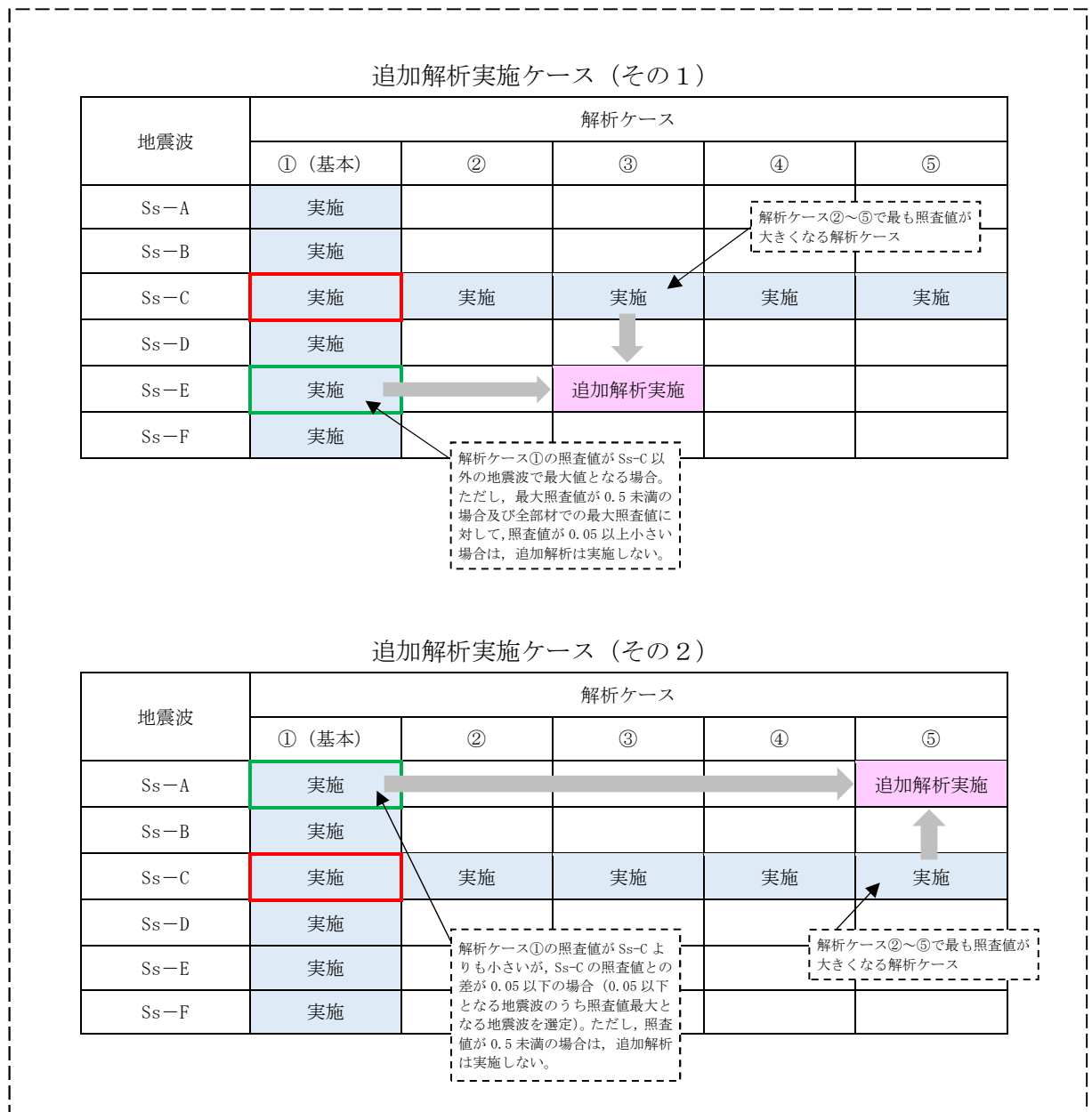
図 2-2 せん断力照査における追加解析ケース選定方法の概念図
