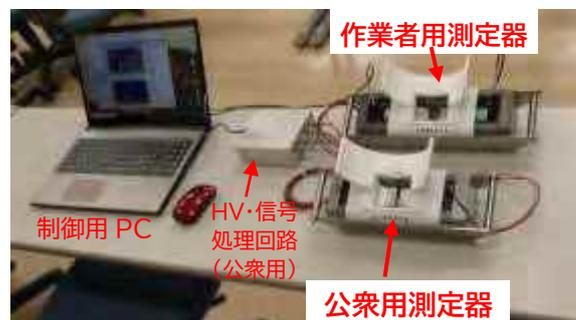
図1 製作した甲状腺モニタの写真
