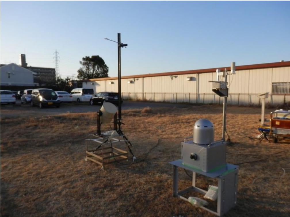
図 11 基準電離箱への照射風景
