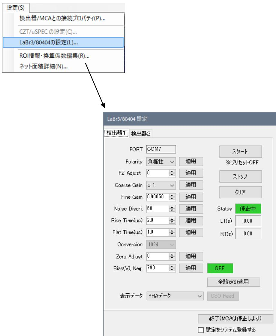
設定は **Bias** を除いて検出器 1、検出器 2 で独立しており、両者はタブで切り換えができる。入力後に、個々の項目の右側にある [ 適用 ] ボタンをクリックすると設定値を信号処理回路(80404)に送信する。また、この画面での [ スタート ] [ ストップ ] [ クリア ] が有効で、メインウィンドウでスペクトルをモニタしながら波形整形フィルタや増幅器のゲインなどの調整が可能である。この時、プリセットは解除される。
