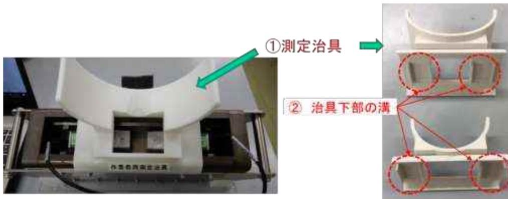
図3-4-1 甲状腺等価線量の測定に用いる測定治具
