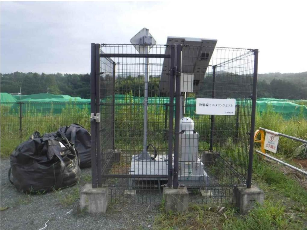
図3 調査を行った双葉町に設置されている可搬型モニタリングポスト
