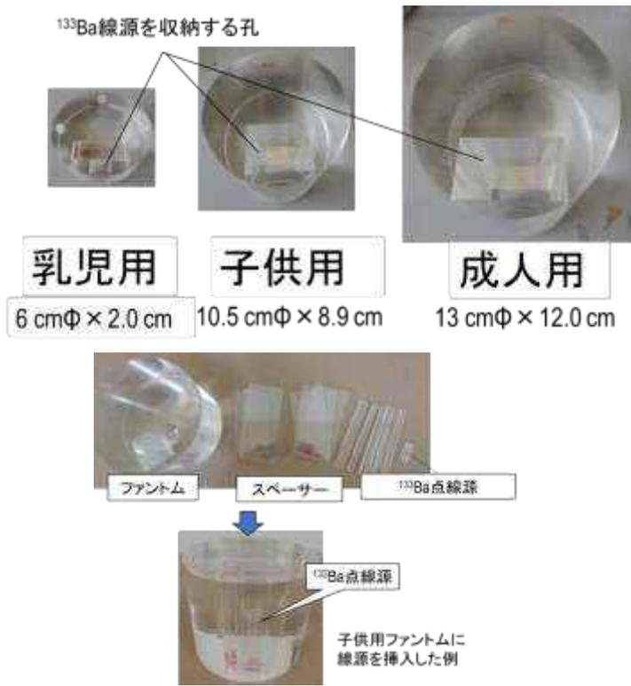
図 3-3-8 甲状腺モニタ校正に使用した簡易物理ファントム（上）
