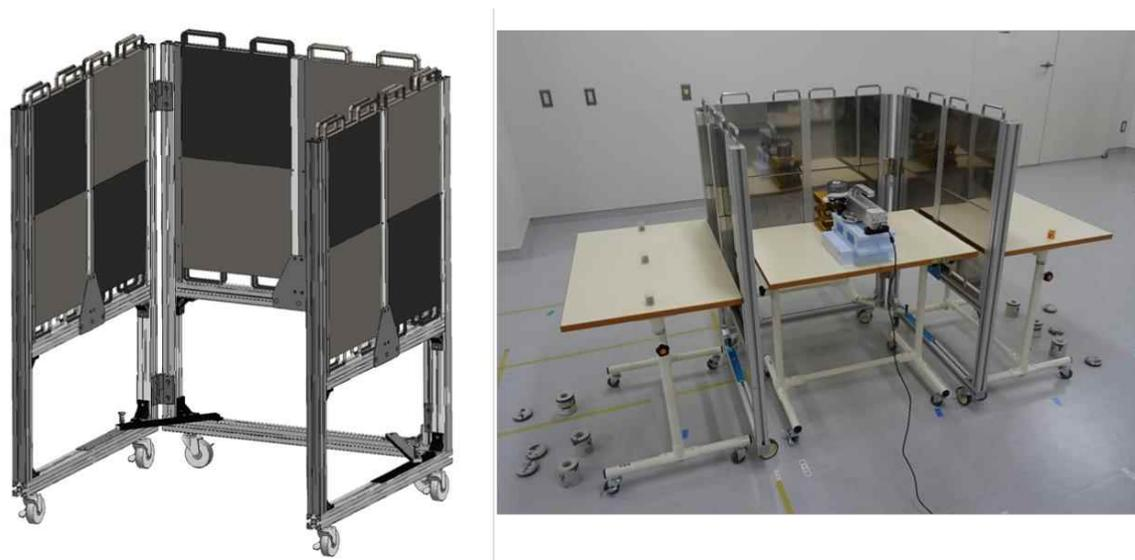
図6 製作した可搬型遮へい体の外観
