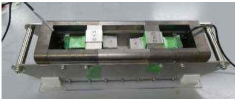
図4-2-2-2-2 改造した作業者用（ $\text{CdZnTe}$  検出器）の検出器遮蔽体
