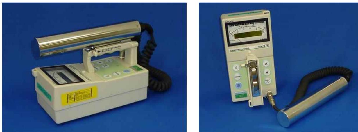
図3 TCS-172Bの外観（右はプローブを外した場合）
