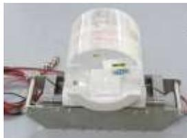
乳児用配置 (PMMA13cm $\Phi$  × 12cm)
