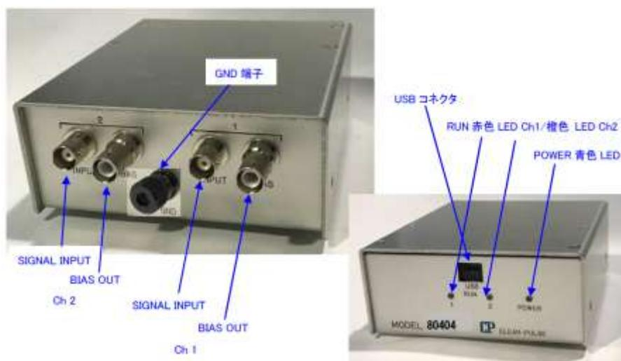
図 4-2-2-3-1 LaBr<sub>3</sub>(Ce)シンチレーション検出器用信号処理装置 (CP model 80404)
