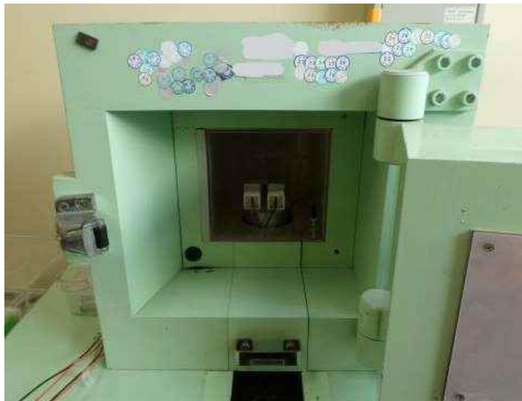
図4-2-3-4-1 Ge 用鉛遮蔽体を用いた LaBr<sub>3</sub>(Ce)シンチレーション検出器の自己バックグラウンド測定の様子
