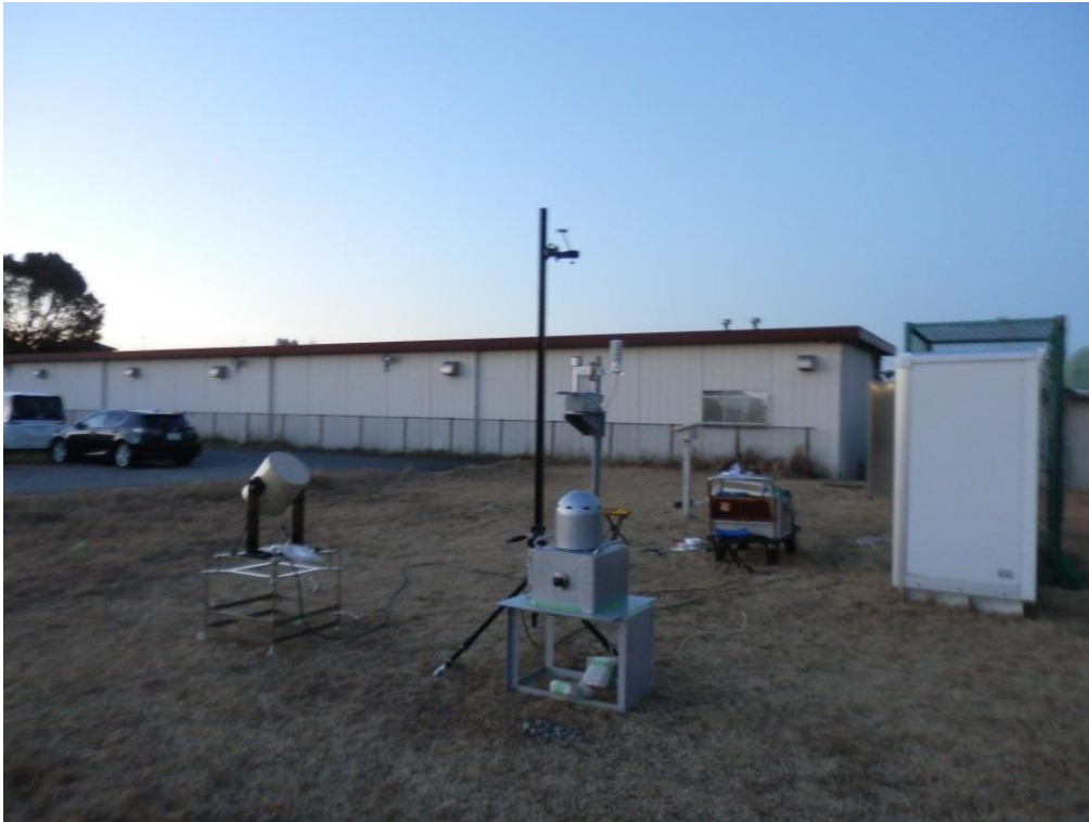
図 2 0 比較正器への照射風景
