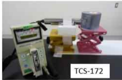
NaIサーベイメータ 換算係数測定
