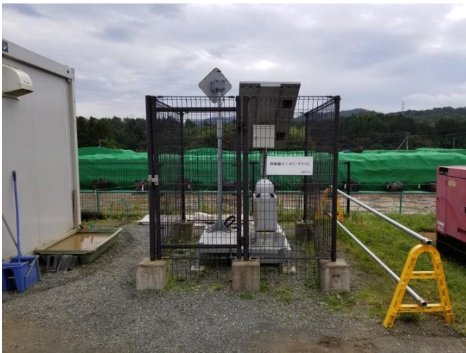
図2 富士電機製 半導体型 (設置地点：双葉町 石熊公民館 (原子力規制庁所有))
