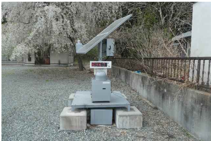
図 3 富士電機製 NaI/半導体型（設置地点：浪江町 小丸多目的集会所（原子力規制庁所有）
