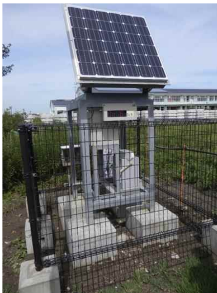
図5 日立製作所製 NaI/半導体型（設置地点：浪江町 請戸局*（福島県所有）
