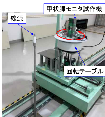
\gamma 線標準場における特性試験
