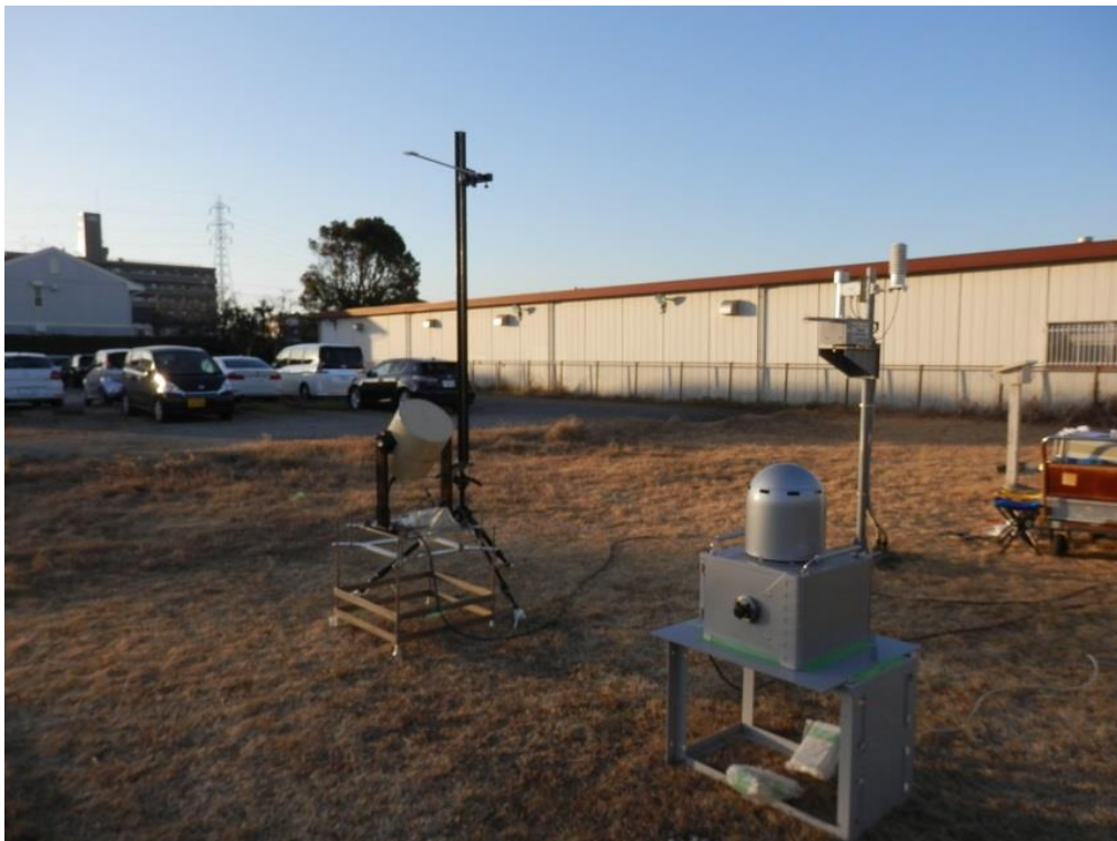
図 2 1 基準電離箱への照射風景
