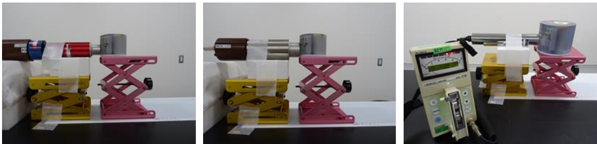
図4 既存検出器によるIRSNファントム測定の様子。
