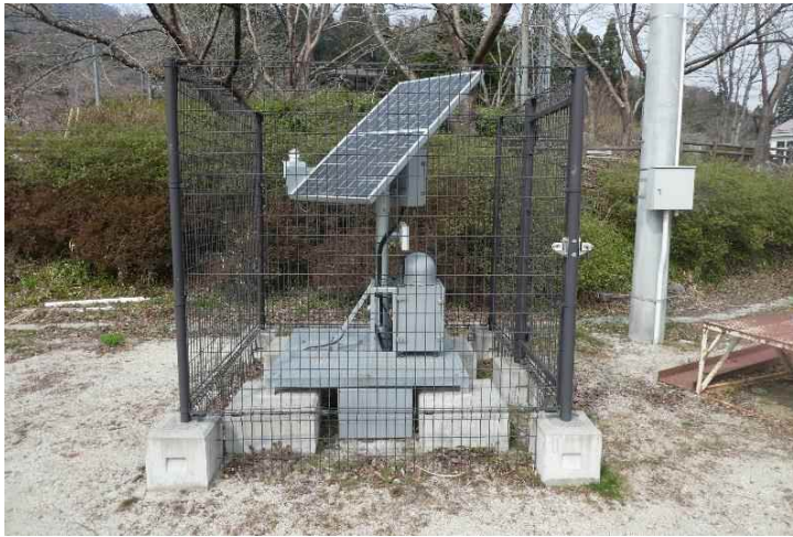
図4 富士電機製 NaI/半導体型（設置地点：飯舘村 大倉体育館*（原子力規制庁所有））
