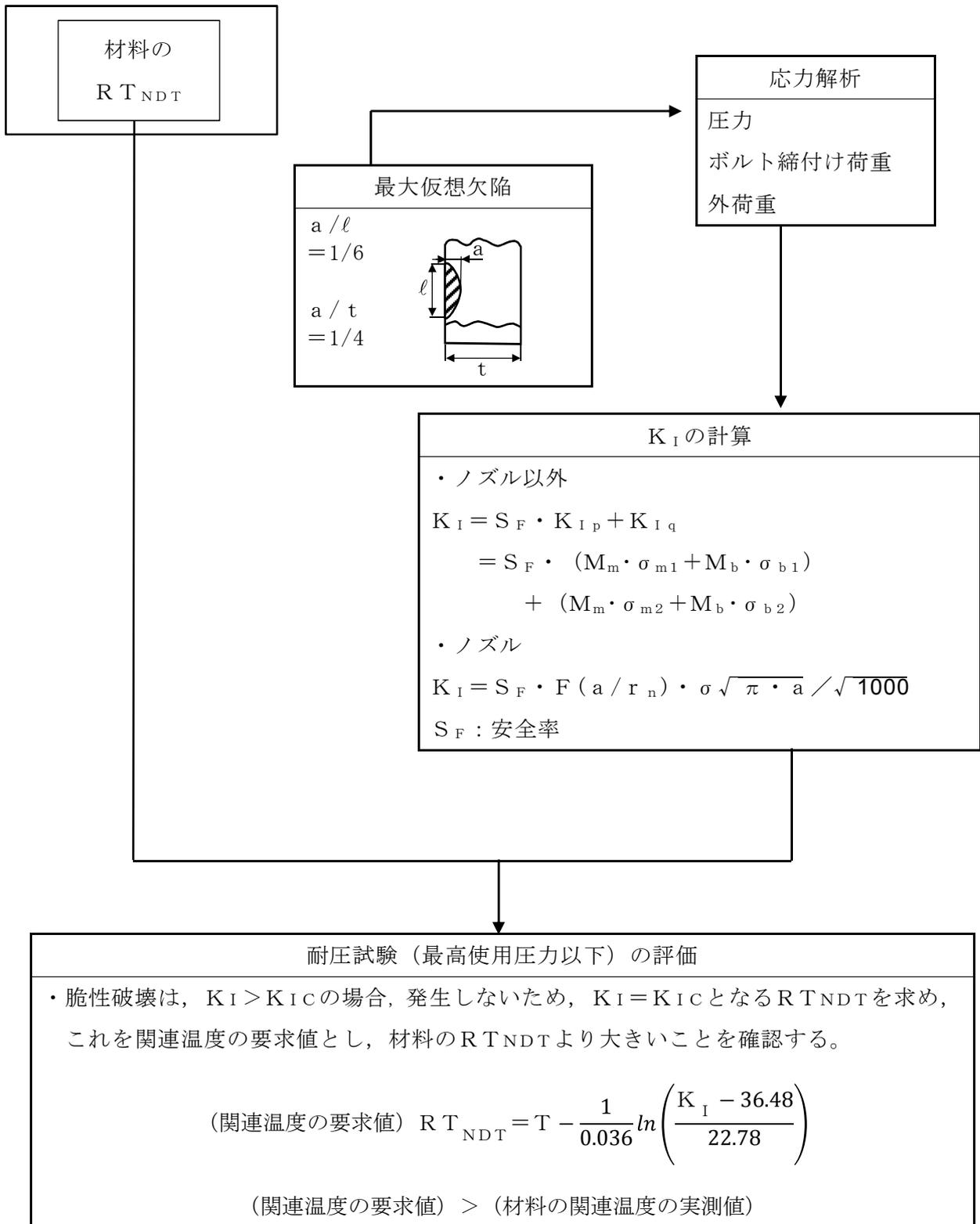
図1 原子炉压力容器材料の脆性破壊防止の評価の流れ
