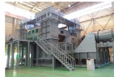
図3 破断試験装置
