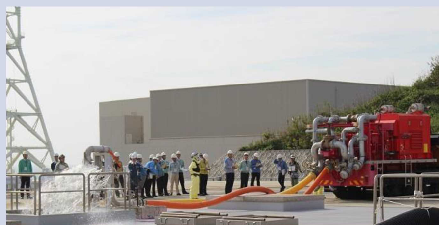
可搬型注水ポンプ車
