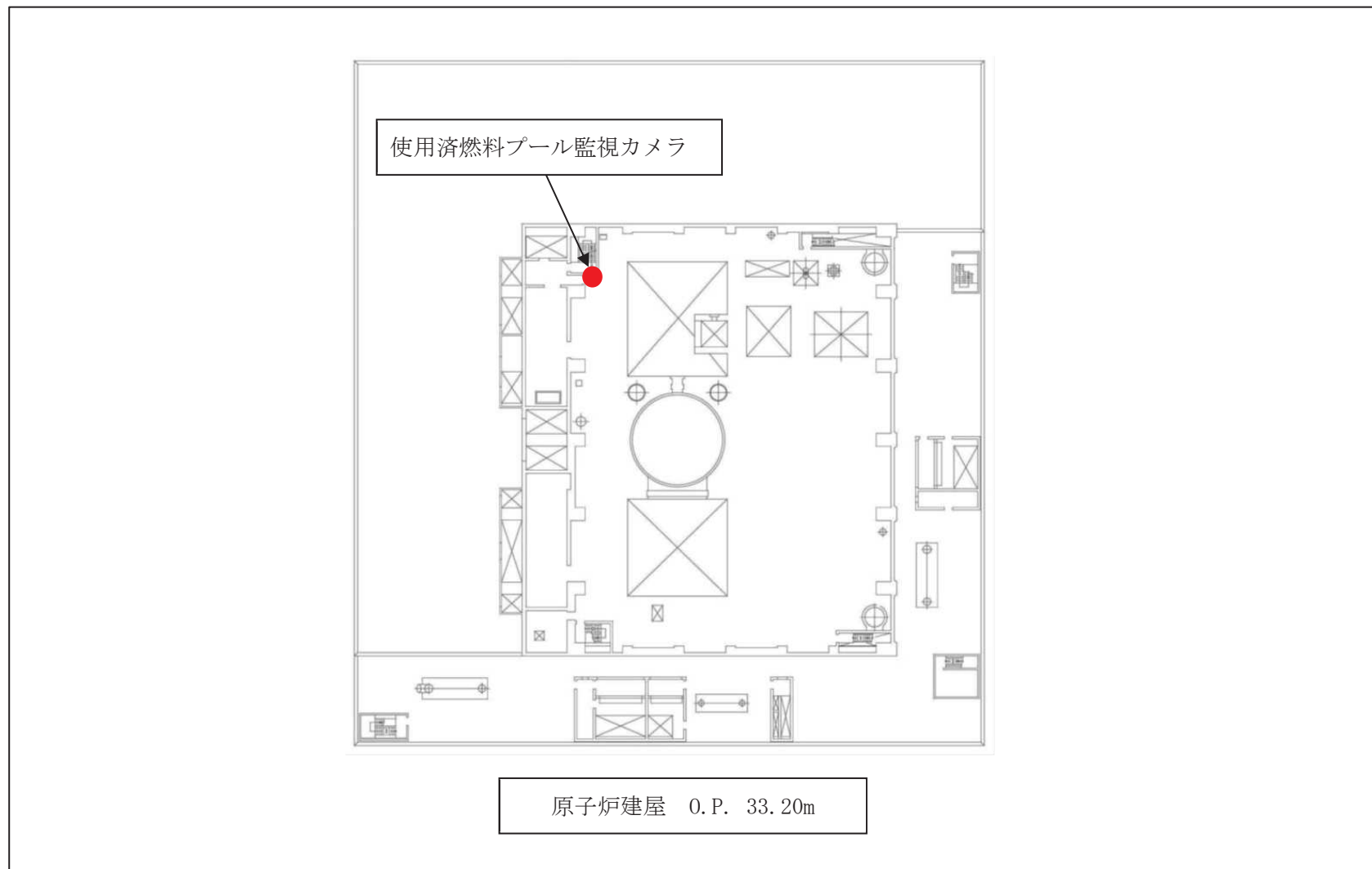
図 3.1-12 使用済燃料プール監視カメラの取付箇所を明示した図面
