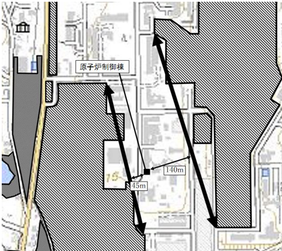
図-2-3-1.12 森林と対象施設との離隔距離（原子炉制御棟）
