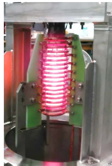
図-7 流下ノズルの加熱状況
