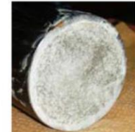
60分保持後、モルタル部からの水漏れ及びにじみなし
