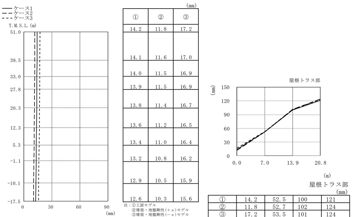
図 4-18 最大応答変位 (Ss-1, 鉛直方向)
