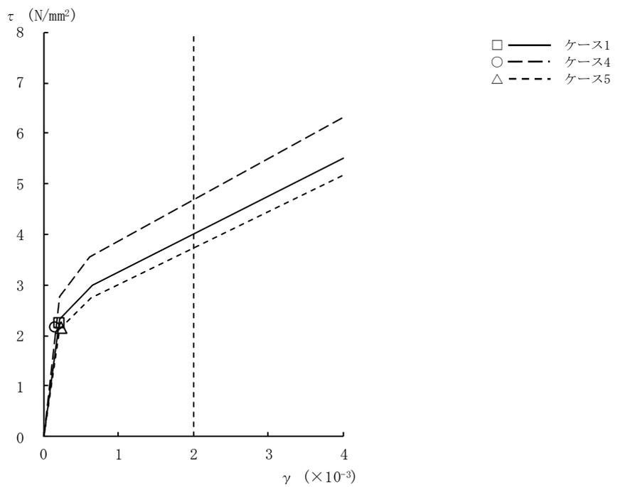
図2-31  $\tau - \gamma$  関係と最大応答値 (Ss-1, NS方向, B3F) (8/9)
