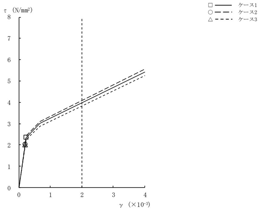
図2-12  $\tau - \gamma$  関係と最大応答値 (Ss-1, NS方向, B4F) (9/9)
