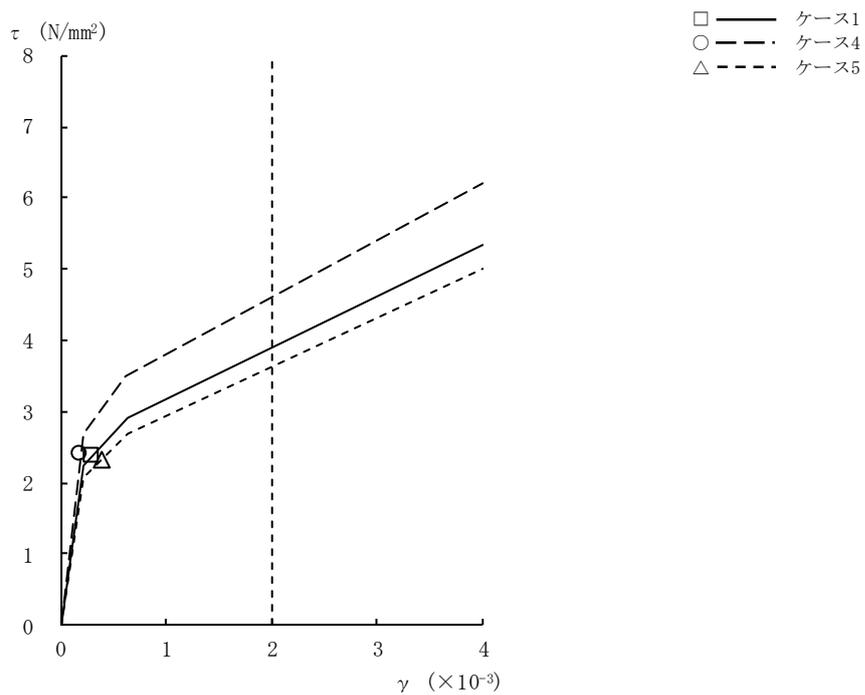
図2-36 τ - γ 関係と最大応答値 (Ss-2, EW方向, B2F) (7/9)
