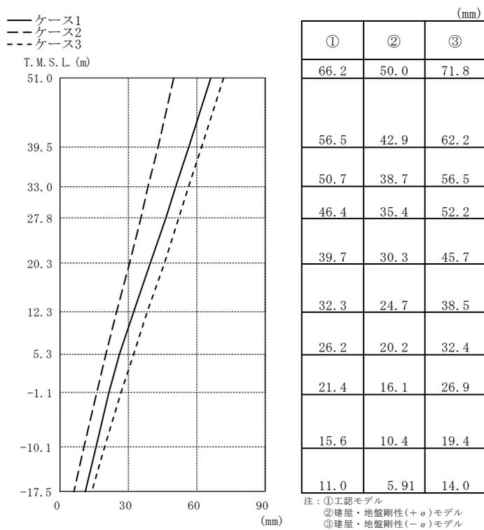
図 4-14 最大応答変位 (Ss-1, EW 方向)
