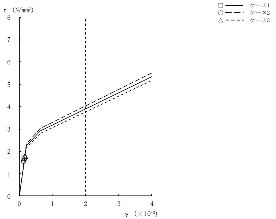
図2-18  $\tau - \gamma$  関係と最大応答値 (Ss-3, EW方向, B2F) (7/9)
