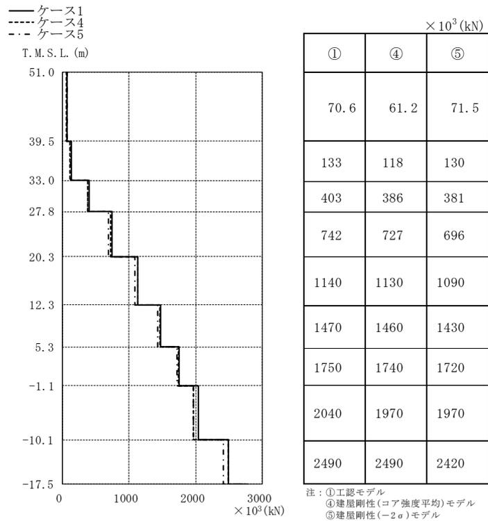
図 4-34 最大応答せん断力 (Ss-1, EW 方向)
