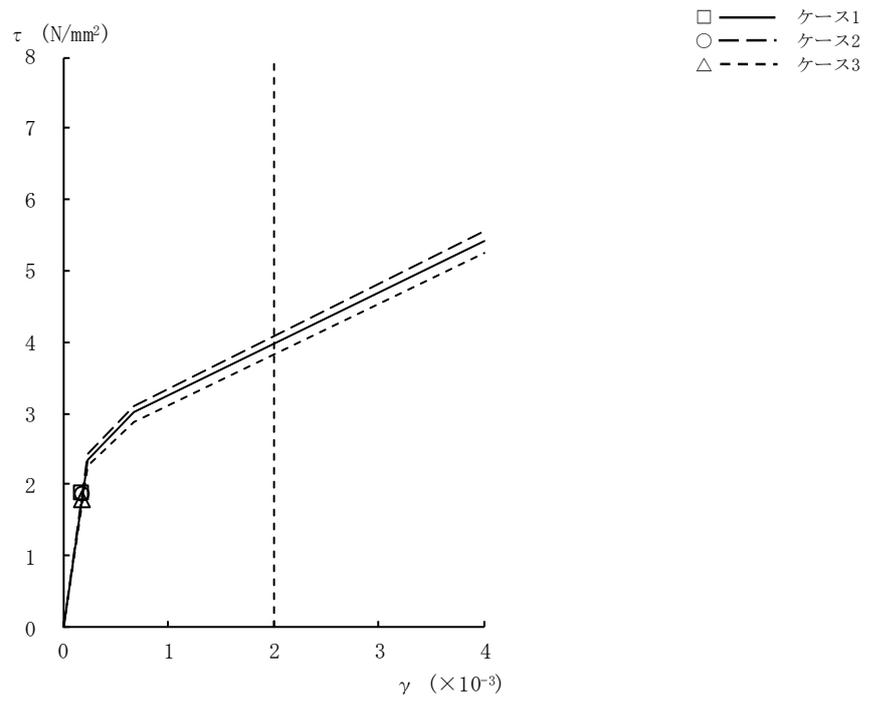
図2-14  $\tau - \gamma$  関係と最大応答値 (Ss-3, NS方向, B4F) (9/9)
