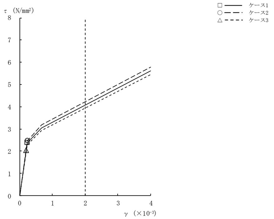
図2-17  $\tau - \gamma$  関係と最大応答値 (Ss-2, EW方向, B4F) (9/9)
