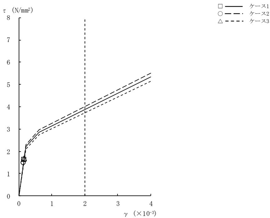
図2-14  $\tau - \gamma$  関係と最大応答値 (Ss-3, NS方向, B1F) (6/9)
