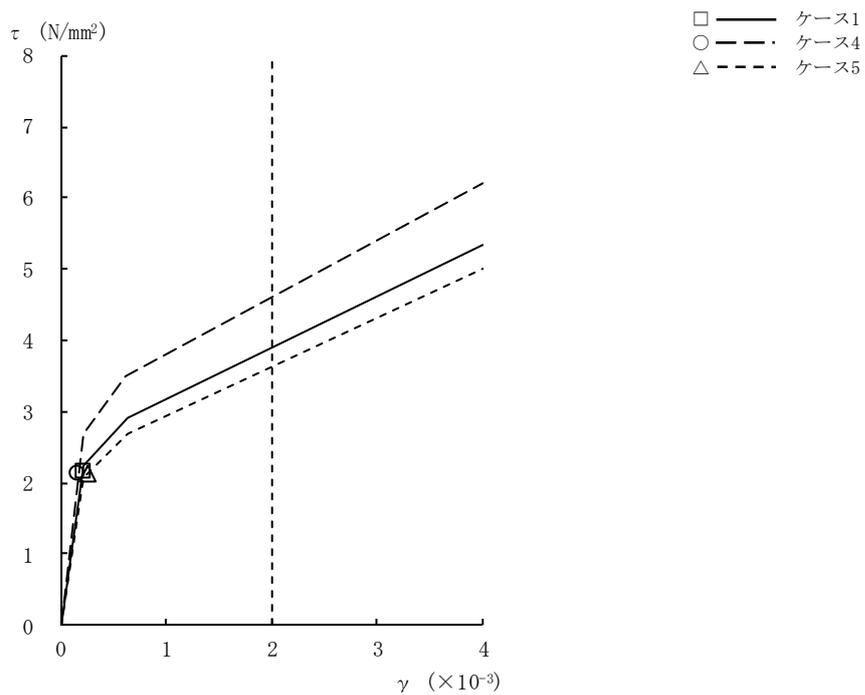
図2-38  $\tau - \gamma$  関係と最大応答値 (Ss-8, EW方向, B2F) (7/9)
