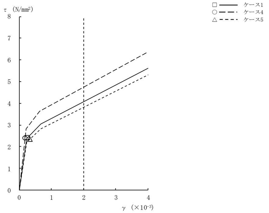
図2-35 τ - γ 関係と最大応答値 (Ss-1, EW方向, B4F) (9/9)
