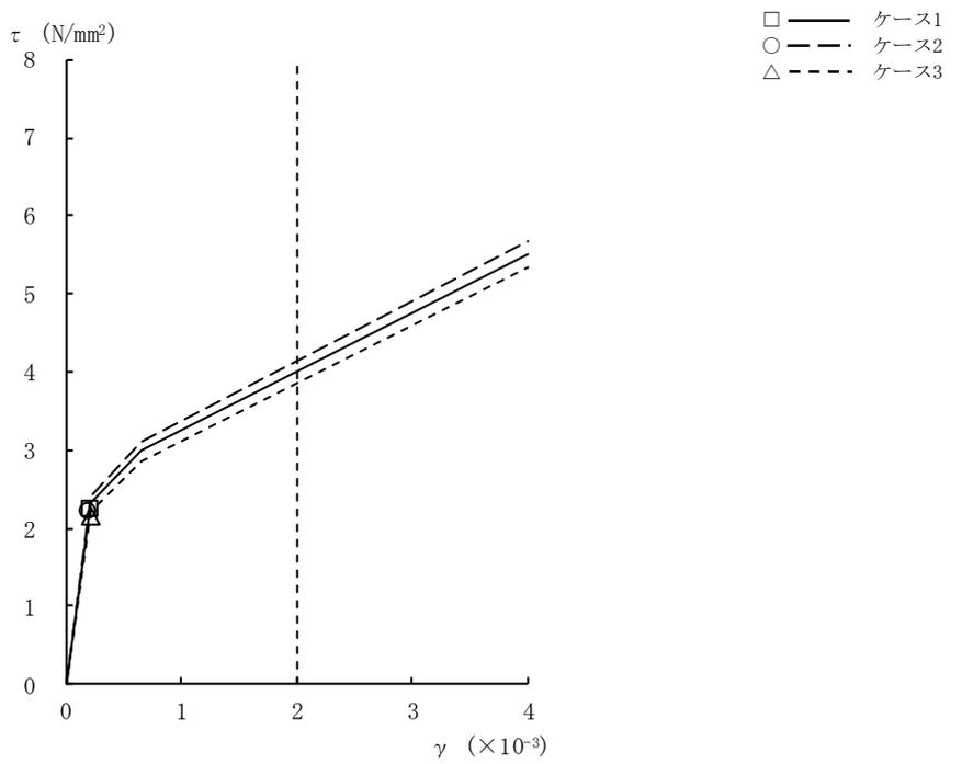
図2-12  $\tau - \gamma$  関係と最大応答値 (Ss-1, NS方向, B3F) (8/9)
