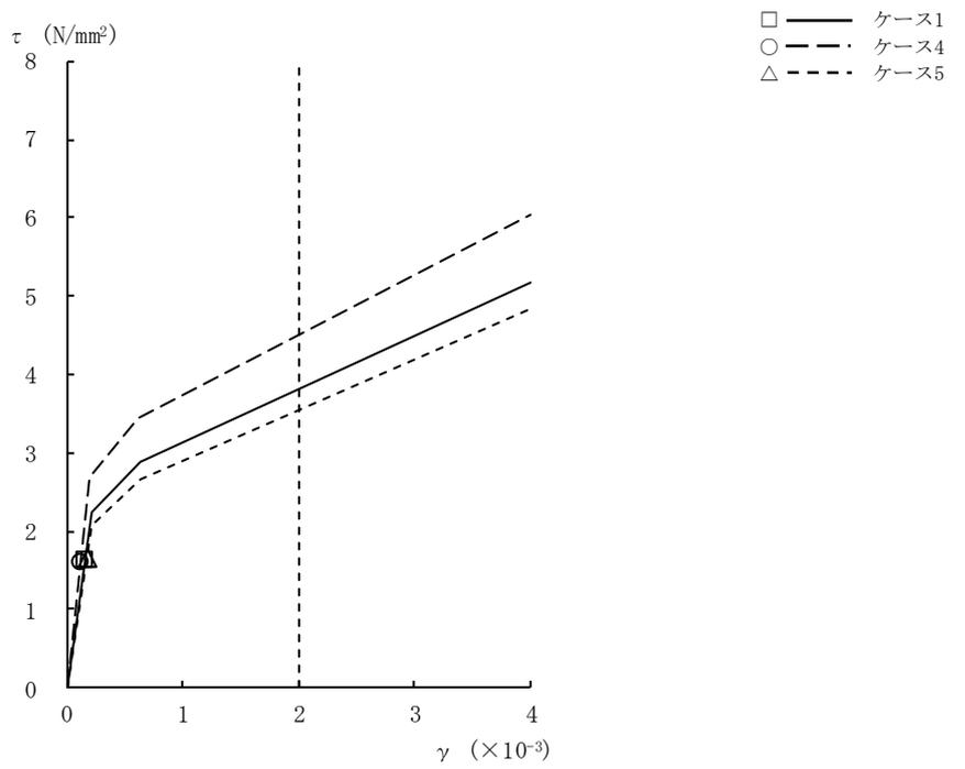
図2-33  $\tau - \gamma$  関係と最大応答値 (Ss-3, NS方向, B2F) (7/9)
