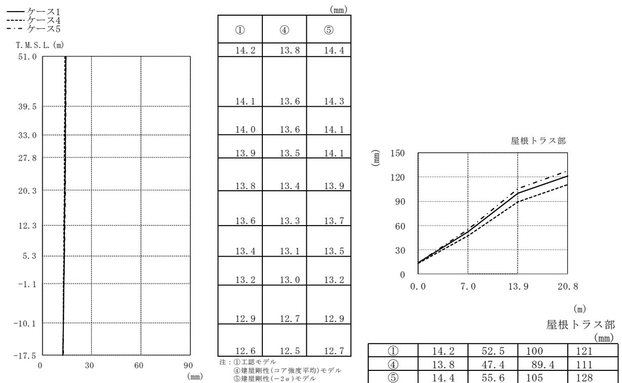
図 4-37 最大応答変位 (S<sub>s</sub>-1, 鉛直方向)
