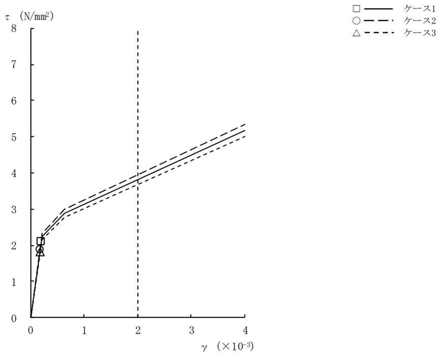
図2-12  $\tau - \gamma$  関係と最大応答値 (Ss-1, NS方向, B2F) (7/9)
