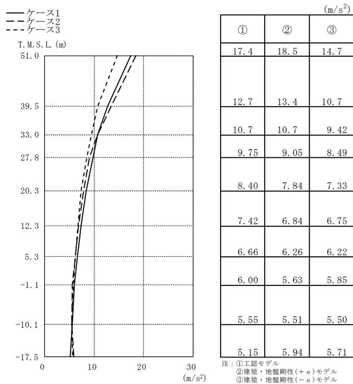
図 4-13 最大応答加速度 (Ss-1, EW 方向)
