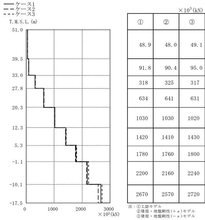
図 4-19 最大応答軸力 (SS-1, 鉛直方向)
