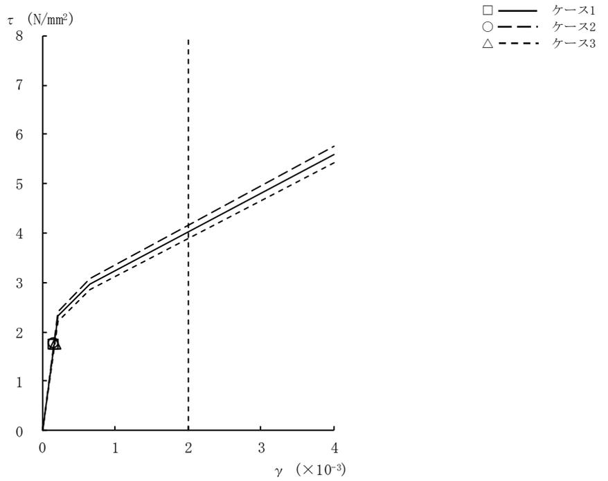
図2-18  $\tau - \gamma$  関係と最大応答値 (Ss-3, EW方向, B3F) (8/9)
