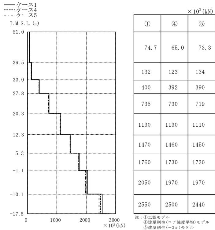
図 4-30 最大応答せん断力 (Ss-1, NS 方向)
