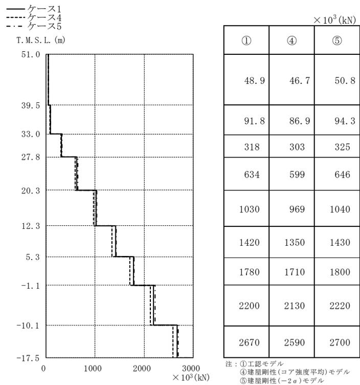
図 4-38 最大応答軸力 (Ss-1, 鉛直方向)
