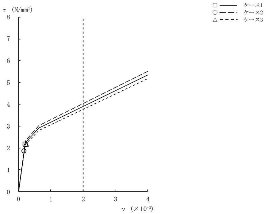
図2-19  $\tau - \gamma$  関係と最大応答値 (Ss-8, EW方向, B2F) (7/9)
