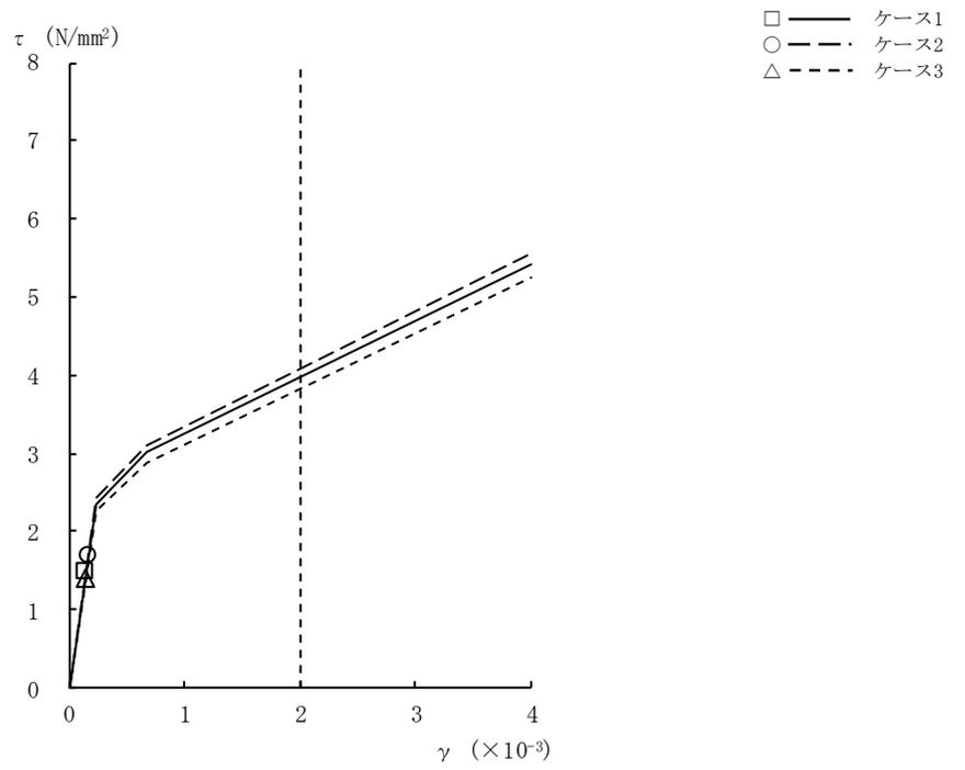
図2-13  $\tau - \gamma$  関係と最大応答値 (Ss-2, NS方向, B4F) (9/9)
