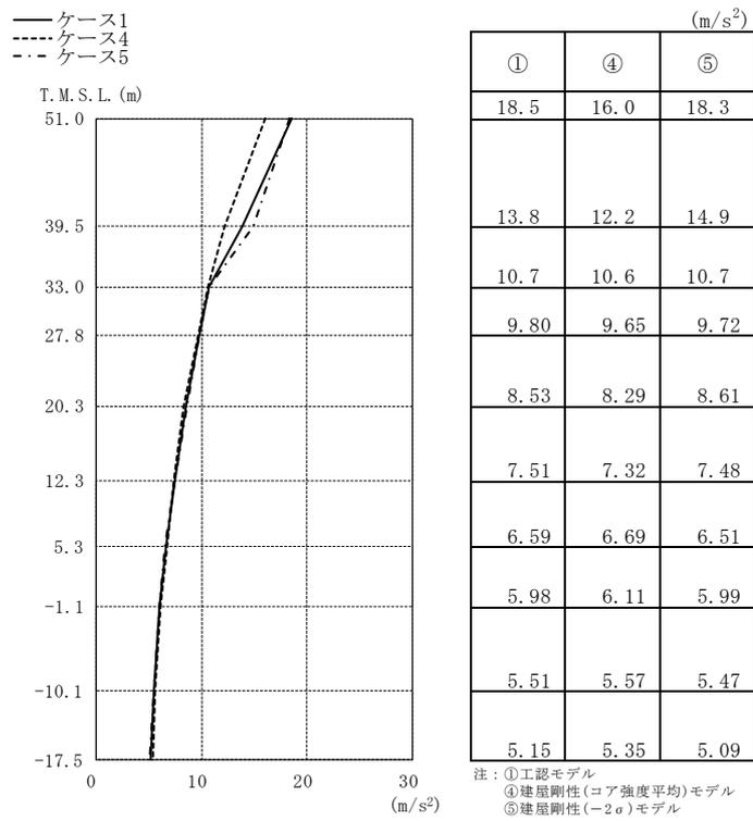
図 4-28 最大応答加速度 (Ss-1, NS 方向)
