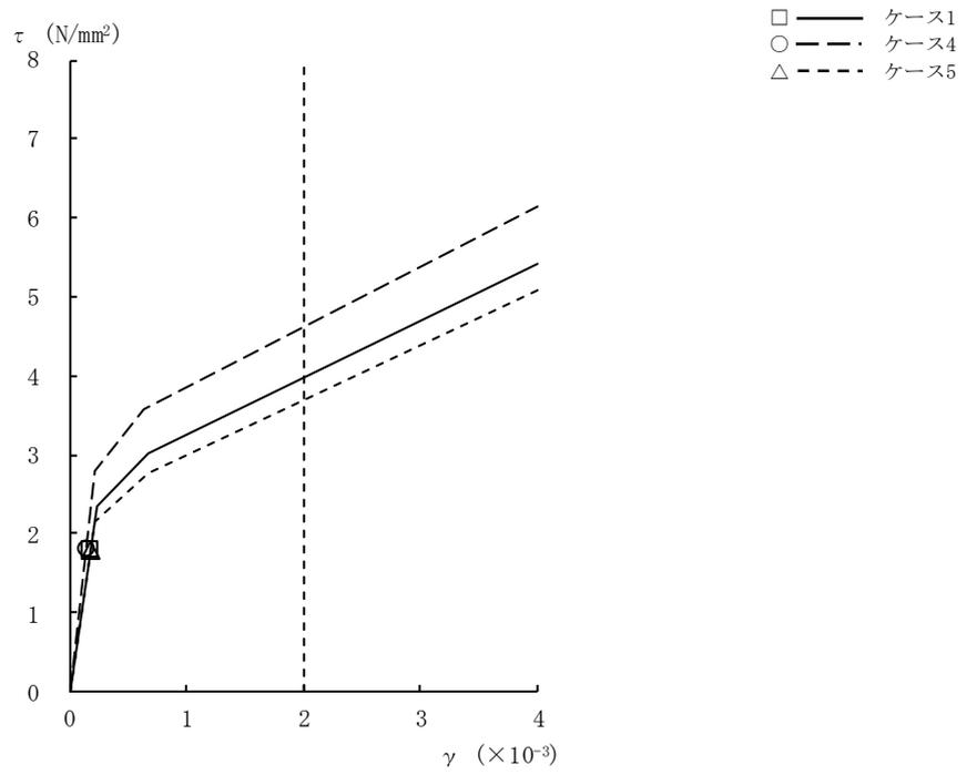
図2-34  $\tau - \gamma$  関係と最大応答値 (Ss-8, NS方向, B4F) (9/9)
