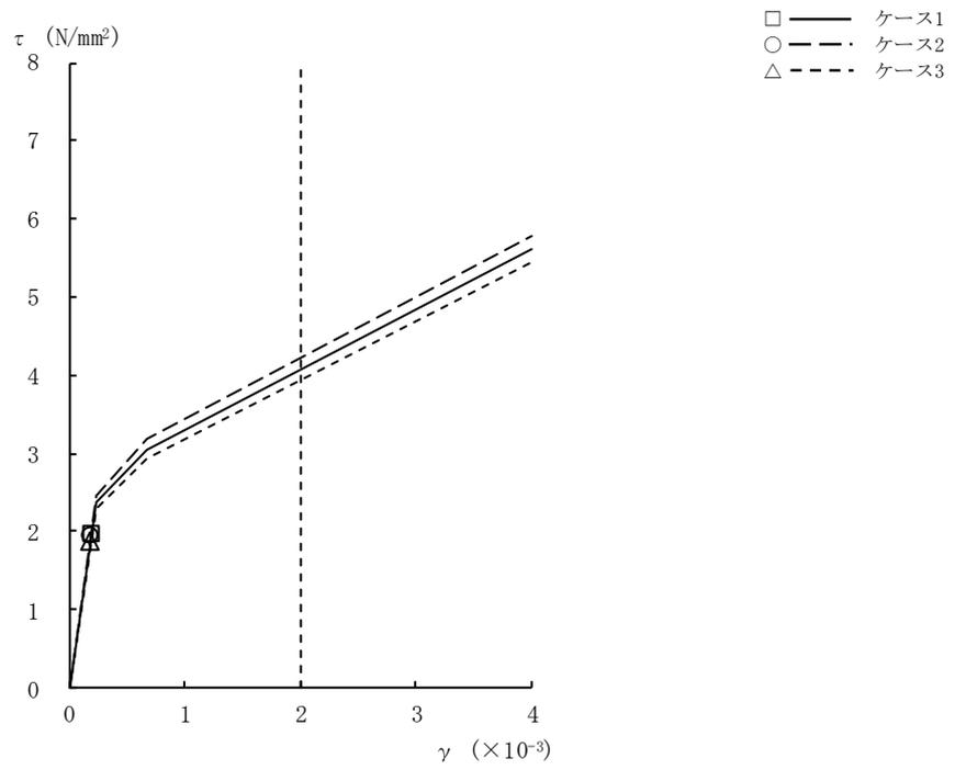
図2-18  $\tau - \gamma$  関係と最大応答値 (Ss-3, EW方向, B4F) (9/9)
