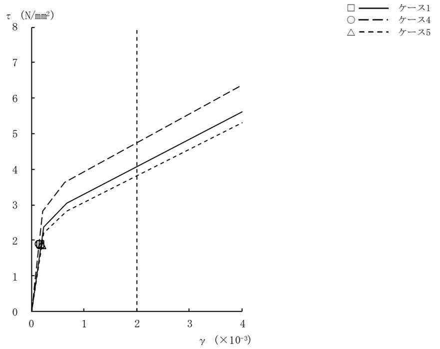
図2-38 τ - γ 関係と最大応答値 (Ss-8, EW方向, B4F) (9/9)
