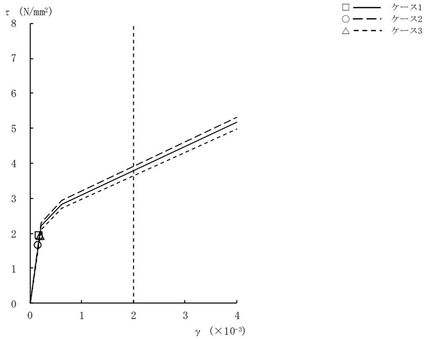
図2-19  $\tau - \gamma$  関係と最大応答値 (Ss-8, EW方向, B1F) (6/9)
