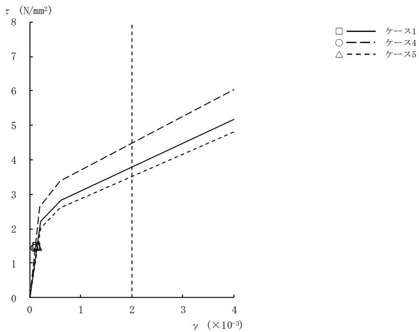
図2-37  $\tau - \gamma$  関係と最大応答値 (Ss-3, EW方向, B1F) (6/9)
