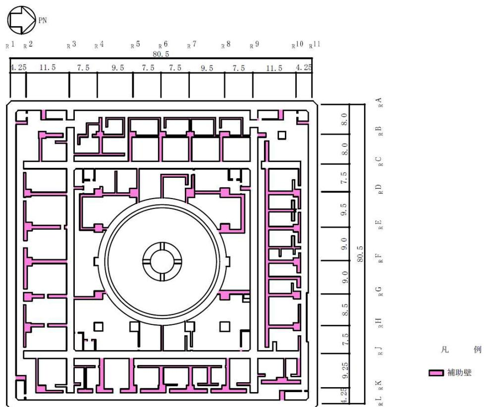
図 2-1 補助壁の考慮範囲の例（B4F，T. M. S. L. -17.5m）
