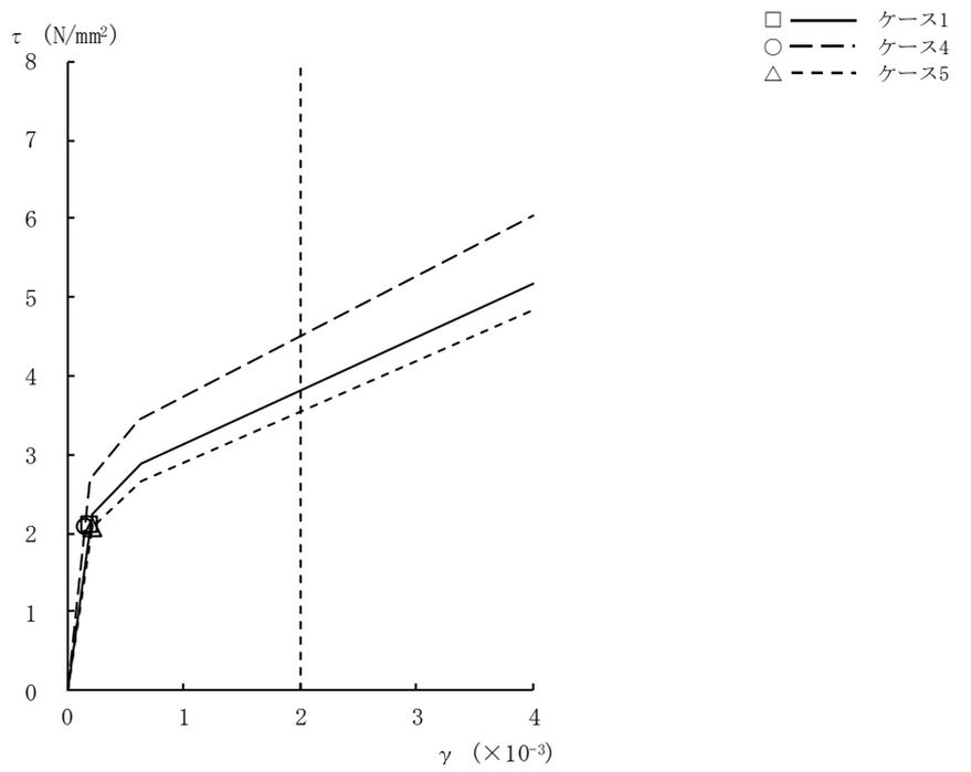
図2-31  $\tau - \gamma$  関係と最大応答値 (Ss-1, NS方向, B2F) (7/9)
