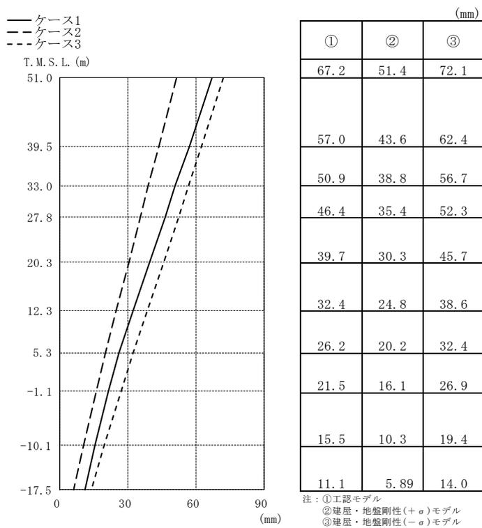
図 4-10 最大応答変位 (Ss-1, NS 方向)
