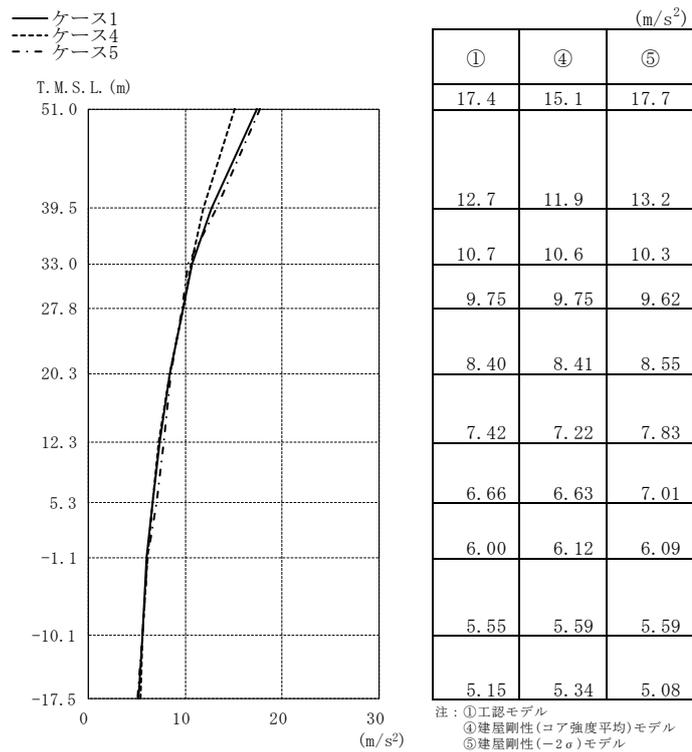
図 4-32 最大応答加速度 (Ss-1, EW 方向)
