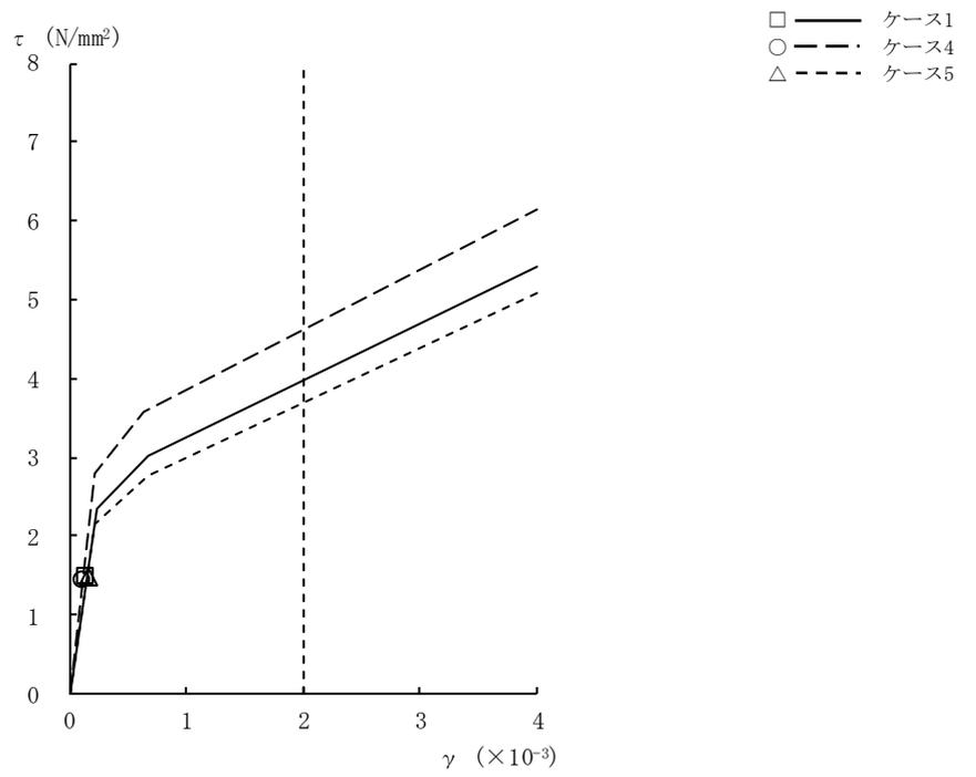
図2-32  $\tau - \gamma$  関係と最大応答値 (S<sub>s</sub>-2, NS方向, B4F) (9/9)
