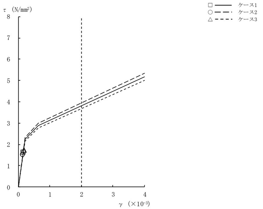
図2-14  $\tau - \gamma$  関係と最大応答値 (Ss-3, NS方向, B2F) (7/9)
