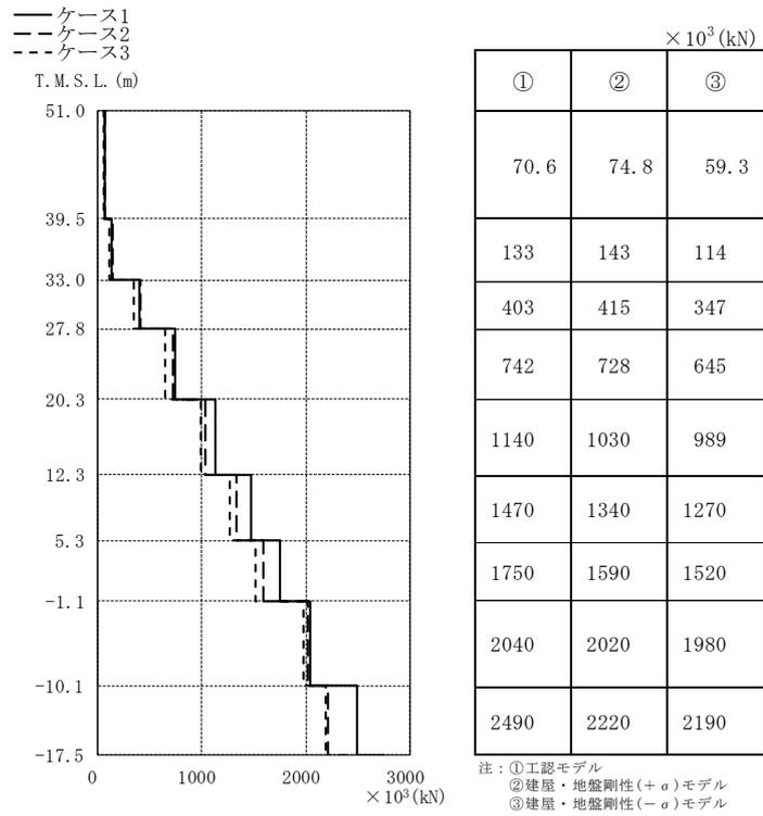
図 4-15 最大応答せん断力 (Ss-1, EW 方向)
