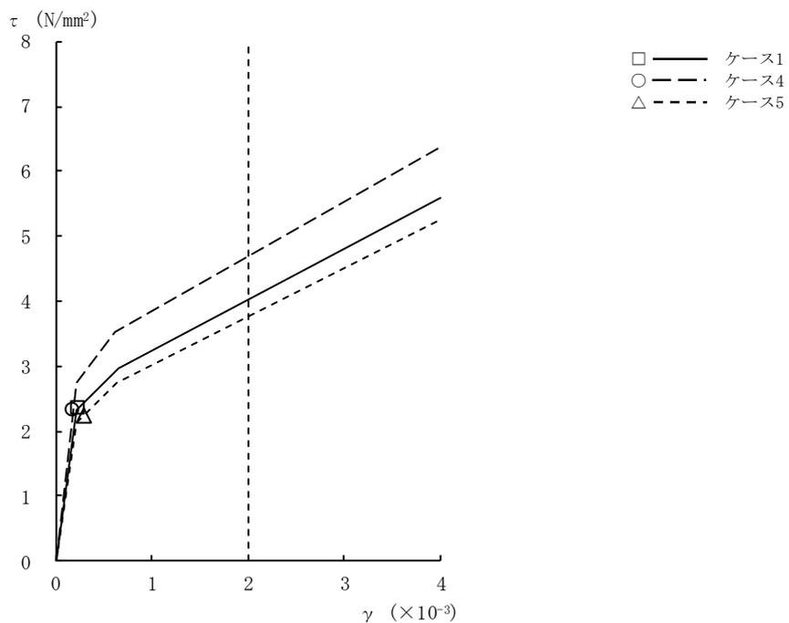
図2-36 τ - γ 関係と最大応答値 (Ss-2, EW方向, B3F) (8/9)
