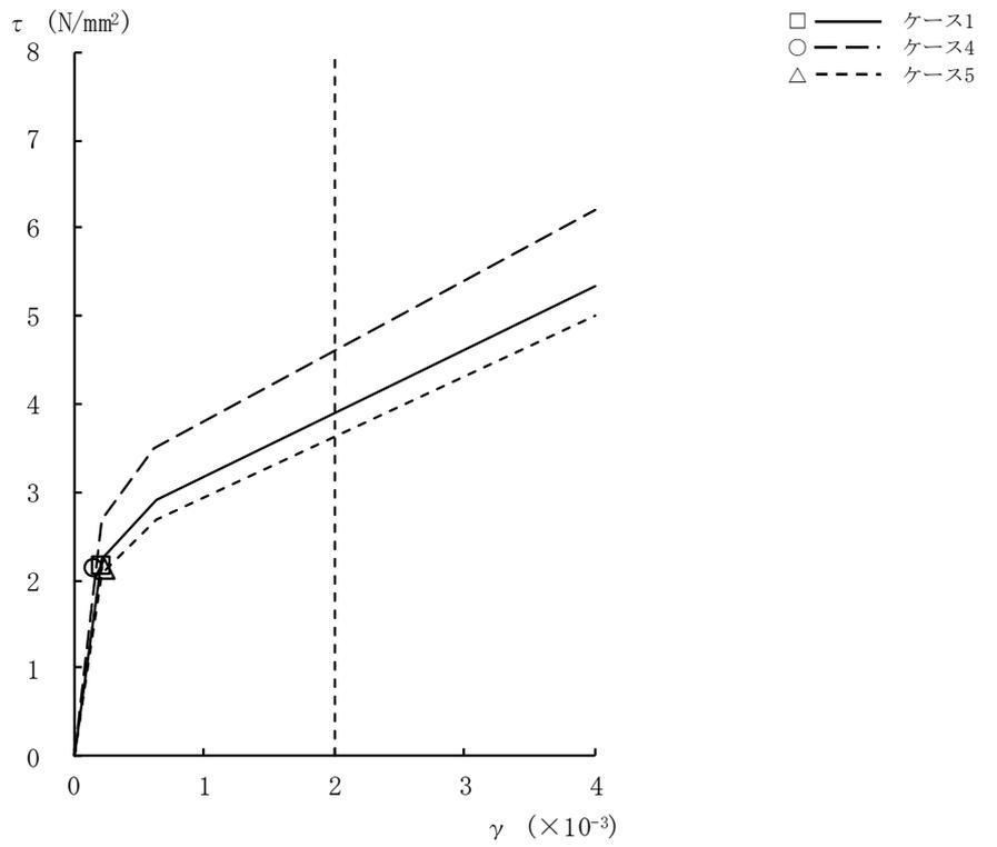
図4-40 τ - γ 関係と最大応答値 (Ss-1, EW方向, B2F) (7/9)
