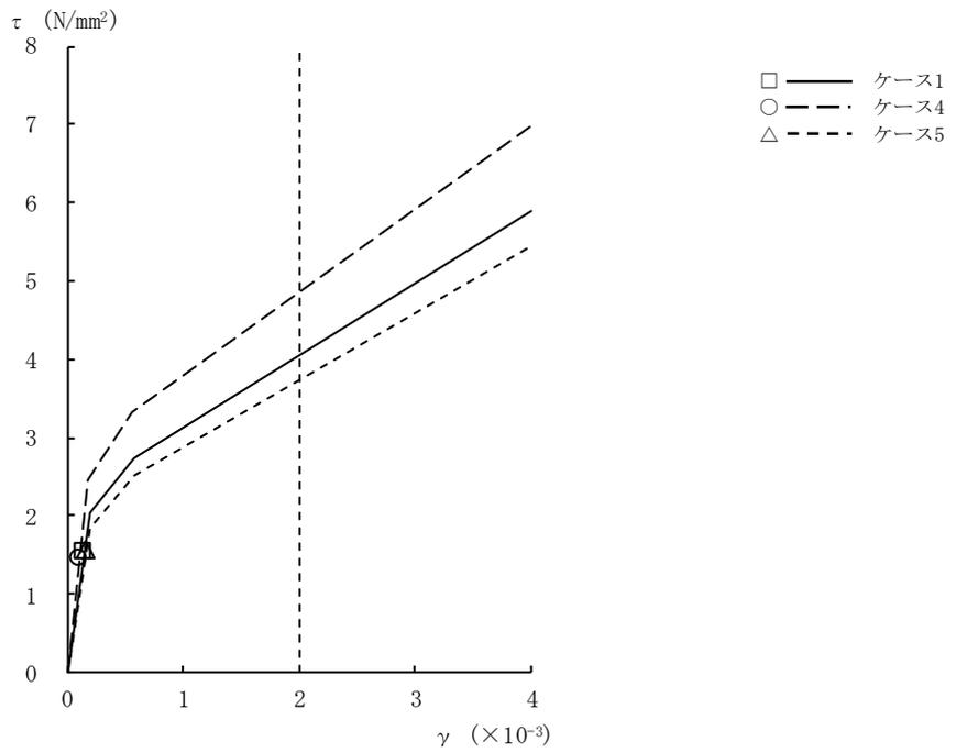
図2-32 τ - γ 関係と最大応答値 (S<sub>S</sub>-2, NS方向, 4F) (2/9)
