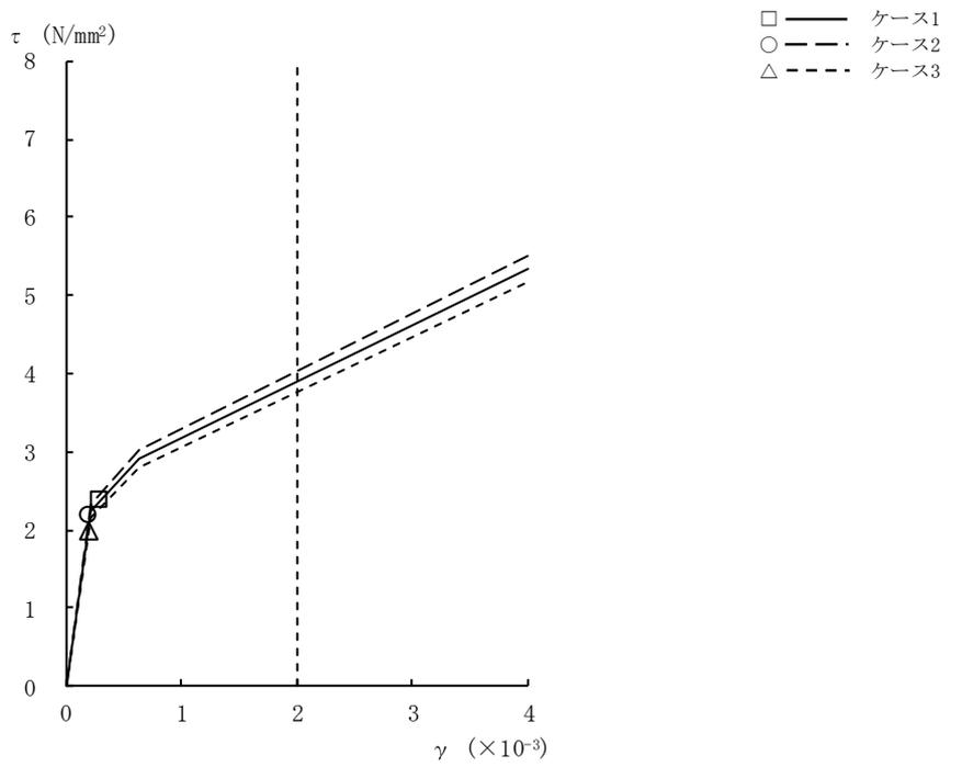
図2-17  $\tau - \gamma$  関係と最大応答値 (Ss-2, EW方向, B2F) (7/9)
