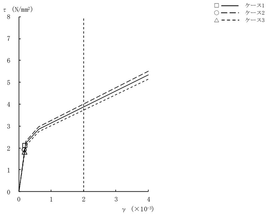
図2-12  $\tau - \gamma$  関係と最大応答値 (Ss-1, NS方向, B1F) (6/9)
