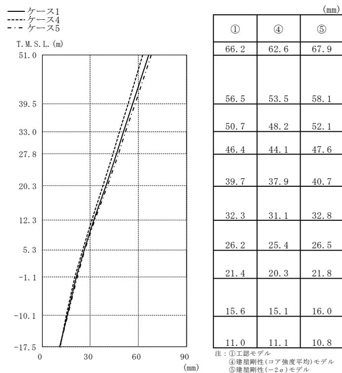
図 4-33 最大応答変位 (Ss-1, EW 方向)
