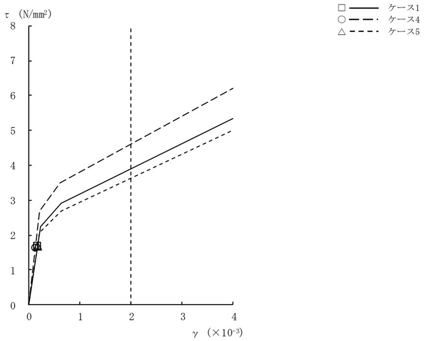
図2-37  $\tau - \gamma$  関係と最大応答値 (Ss-3, EW方向, B2F) (7/9)
