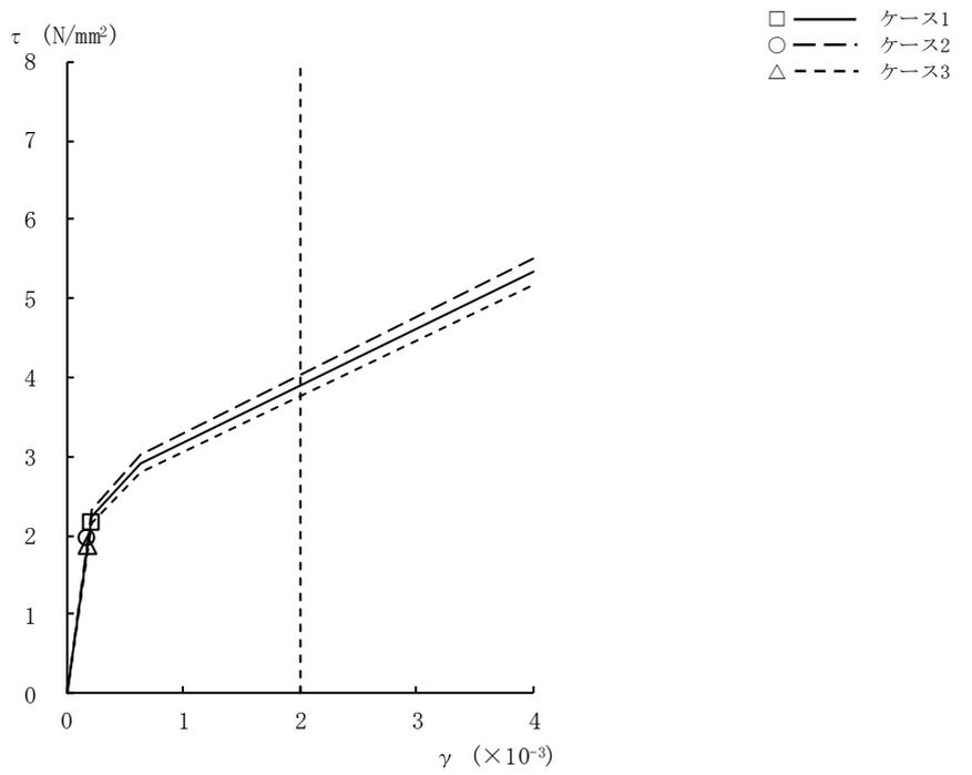
図2-16  $\tau - \gamma$  関係と最大応答値 (Ss-1, EW方向, B2F) (7/9)
