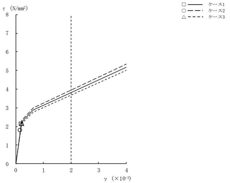
図2-15  $\tau - \gamma$  関係と最大応答値 (Ss-8, NS方向, B2F) (7/9)
