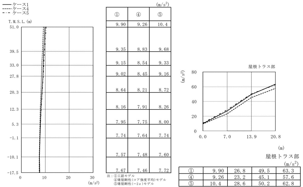
図 4-36 最大応答加速度 (S<sub>s</sub>-1, 鉛直方向)
