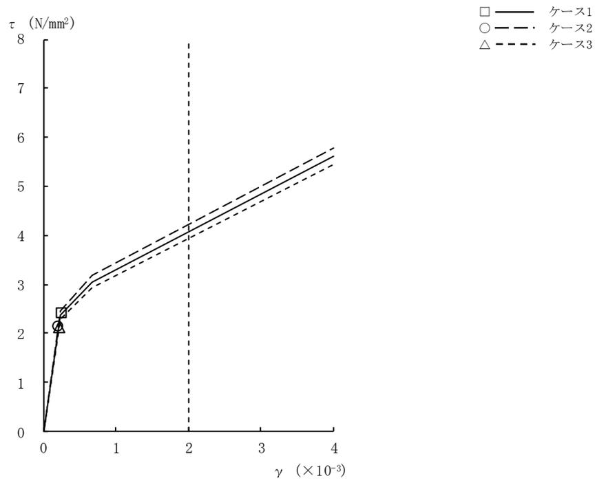
図2-16  $\tau - \gamma$  関係と最大応答値 (Ss-1, EW方向, B4F) (9/9)
