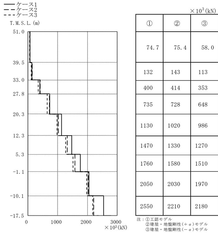
図 4-11 最大応答せん断力 (Ss-1, NS 方向)
