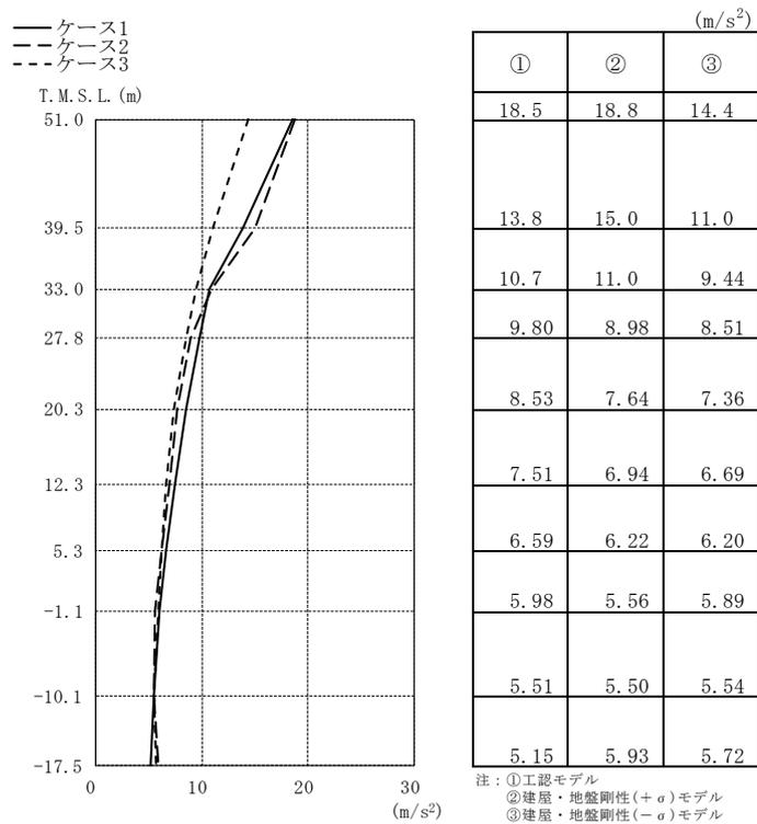
図 4-9 最大応答加速度 (Ss-1, NS 方向)
