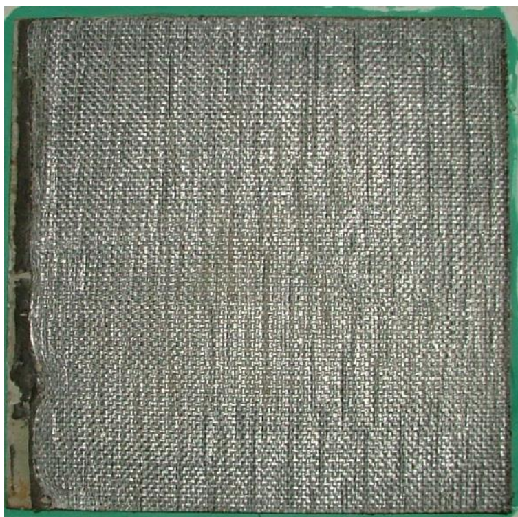
図 3-44 スケール影響試験後の供試体状況 ケース 2-4 (保護層表面)
