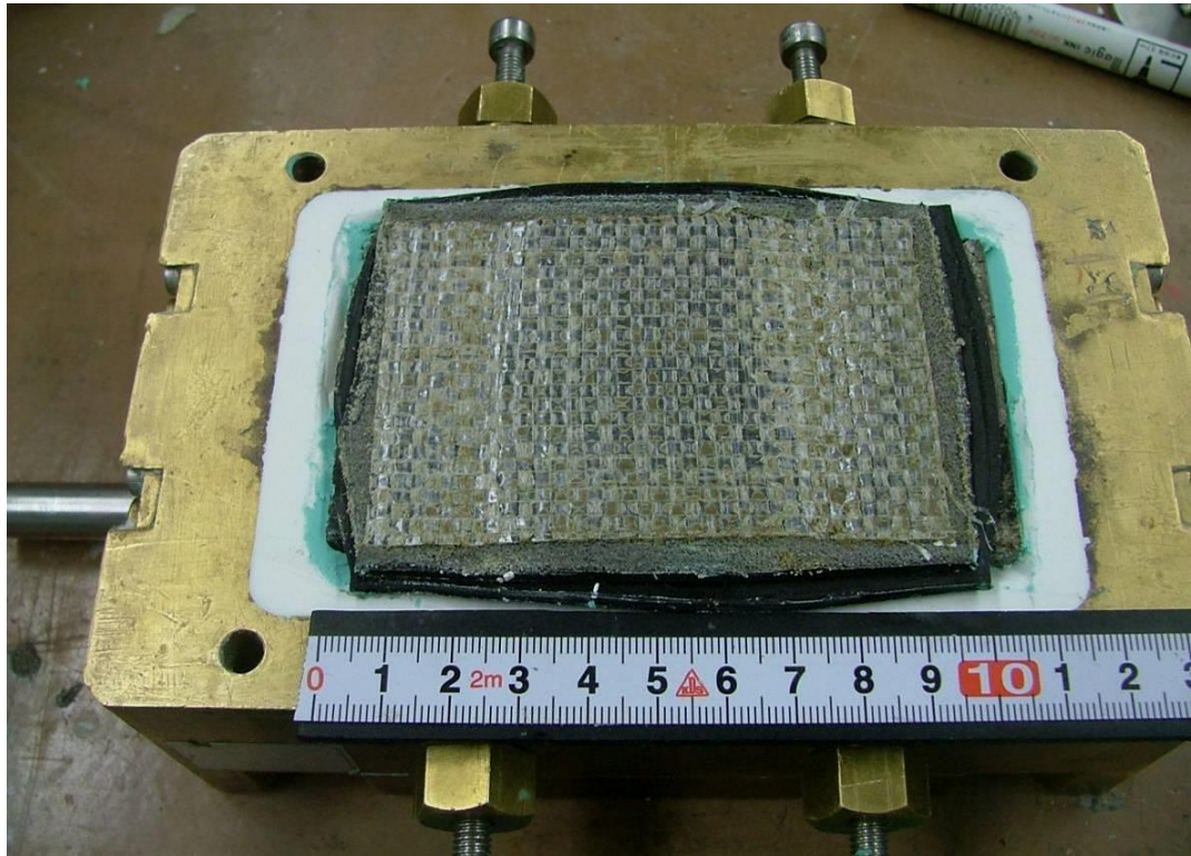
図 3-30 繰返し载荷試験後の供試体状況 ケース 1-8 (保護層表面)
