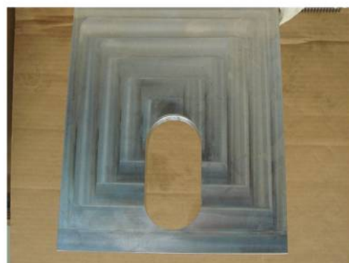
図 4-5 模擬ラグ B (スリット平行) 1 回目試験の試験後の供試体等の状況
