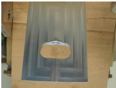
図 4-4 模擬ラグ A (スリット直交) 2 回目試験の試験後の供試体等の状況
