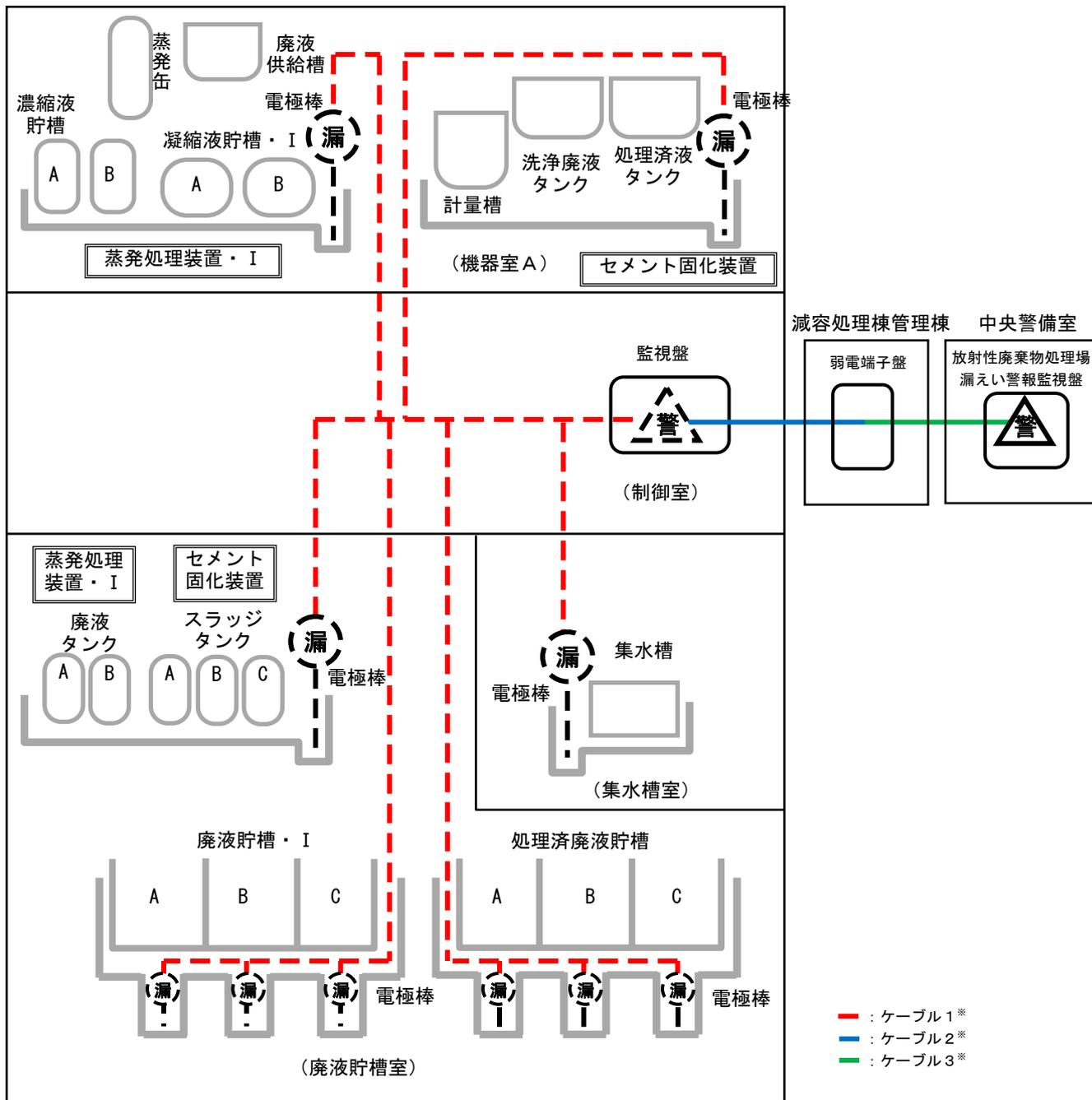
※ ケーブル1、ケーブル2、ケーブル3はc-2に示す。なお、ケーブル3は既設ケーブルであり信号を付加する工事を行う。
