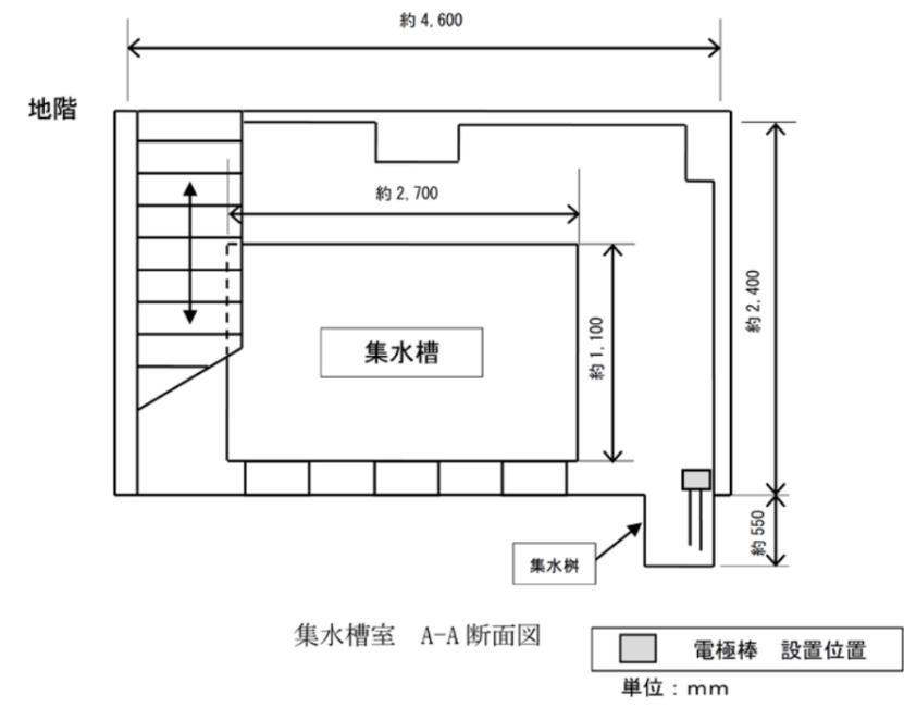
図-4.6 第3廃棄物処理棟の電極棒の配置図（その5）
