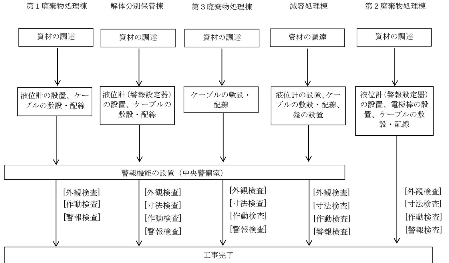
注：当該漏えい警報装置に係る使用前事業者検査終了後に漏えい警報装置を利用する。
