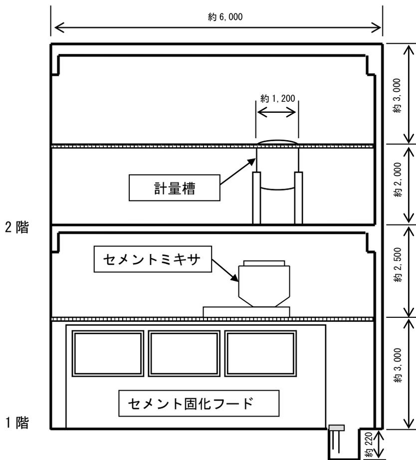
機器室 A セメント固化装置 A-A 断面図
