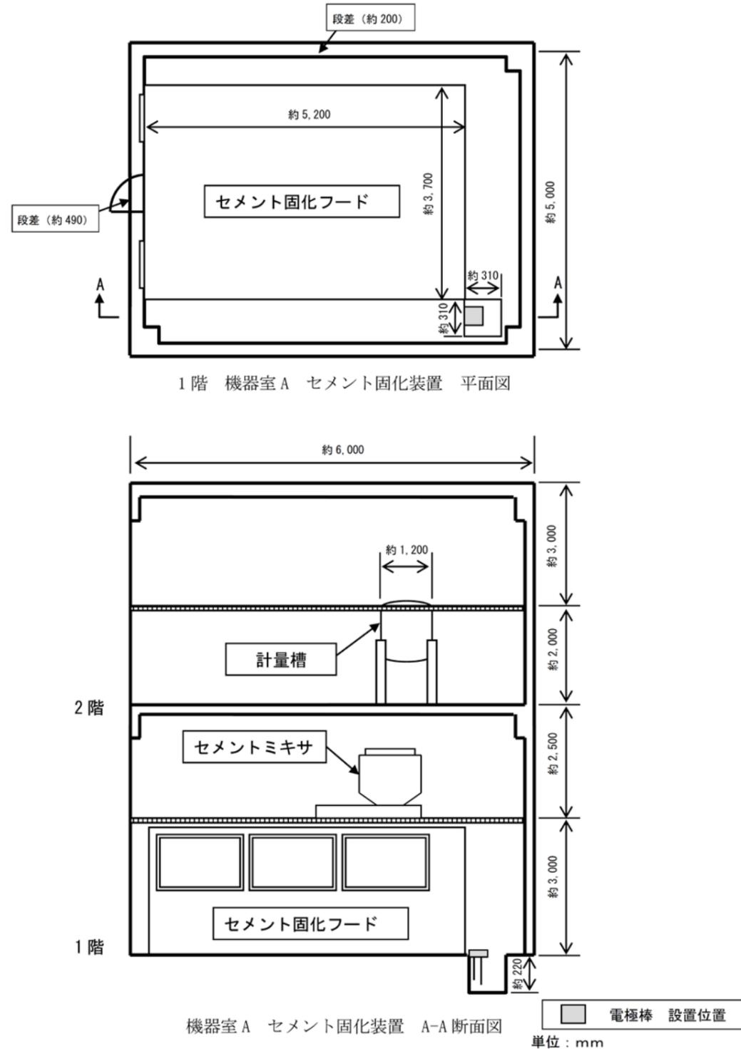
図-4.3 第3廃棄物処理棟の電極棒の配置図（その2）
