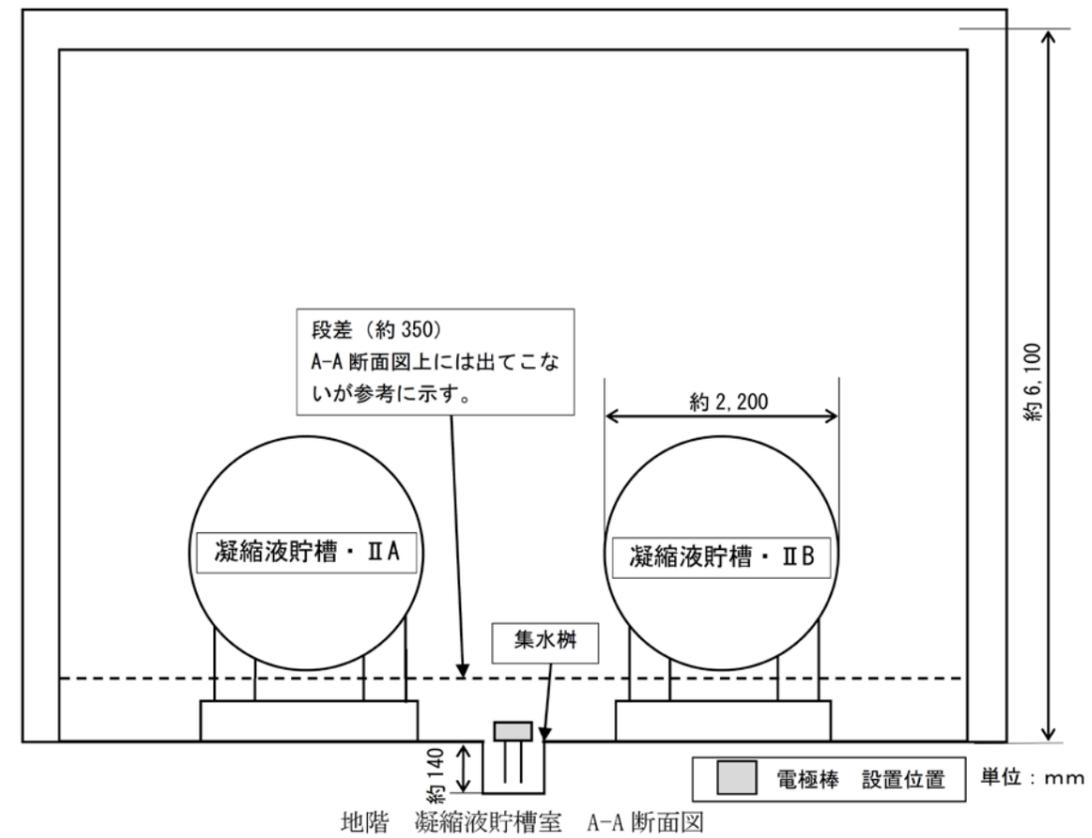
図-3.6 第2廃棄物処理棟の電極棒の配置図（その5）
