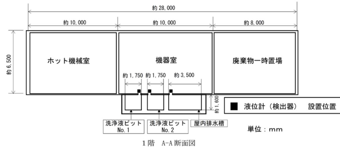
図-2.2 第1廃棄物処理棟の液位計の配置図
