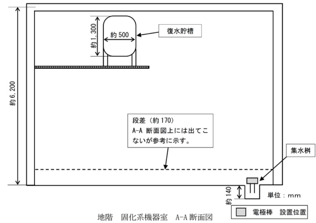
図-3.4 第2廃棄物処理棟の電極棒の配置図（その3）
