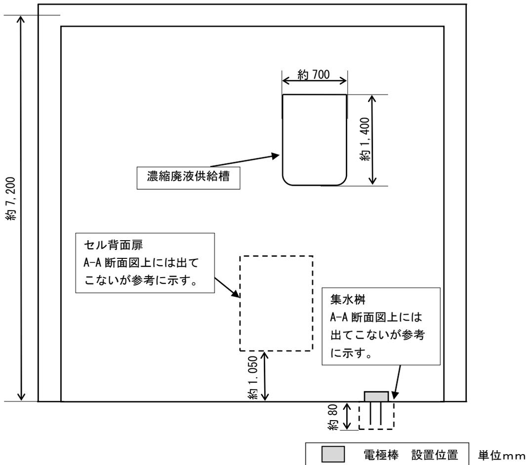
1階 固化セル A-A 断面図
