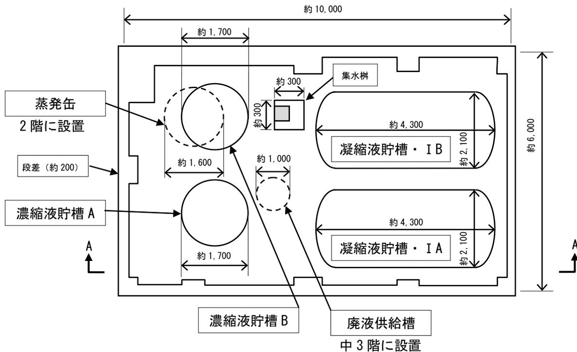
1階 機器室 A 蒸発処理装置・I 平面図
