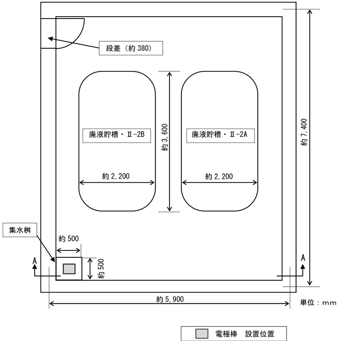
地階 処理前廃液貯槽室 平面図
