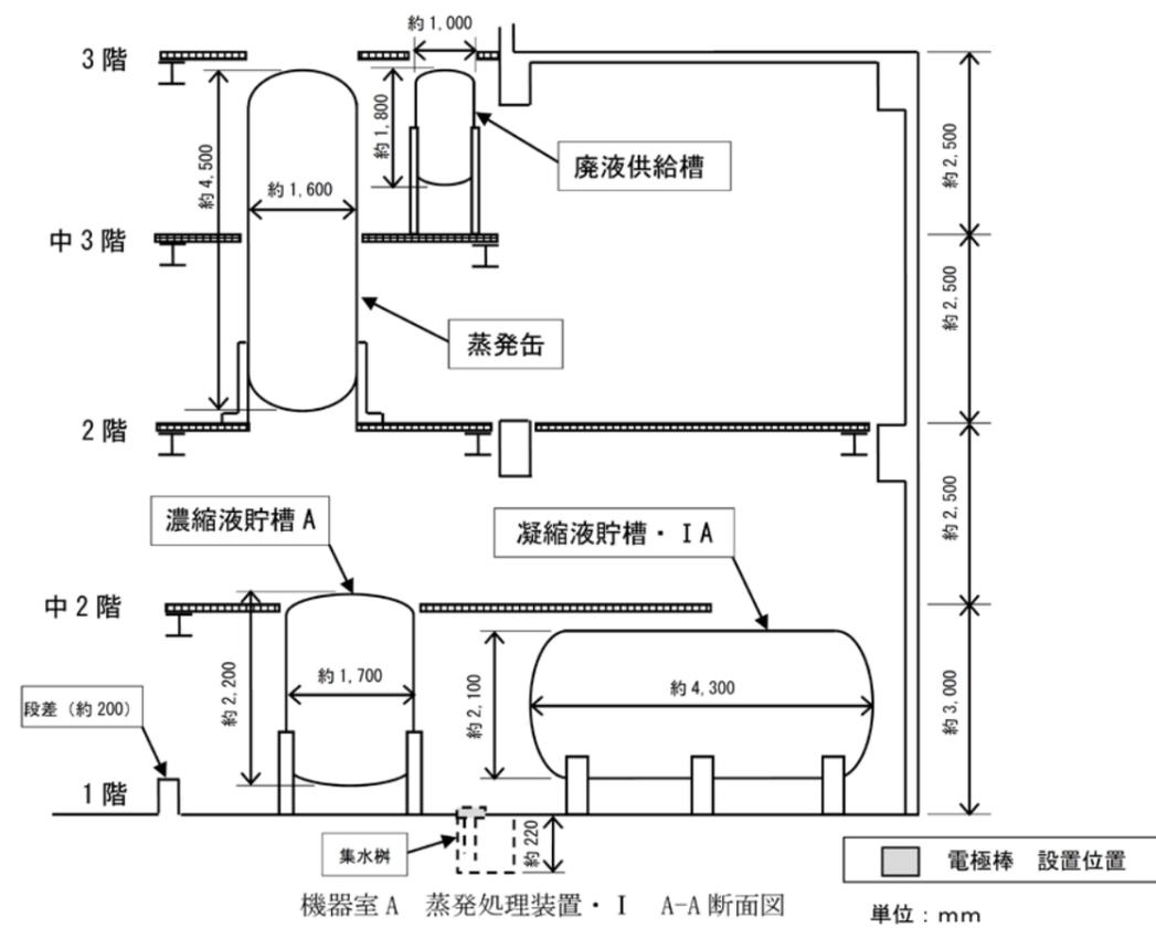
機器室 A 蒸発処理装置・I A-A 断面図
