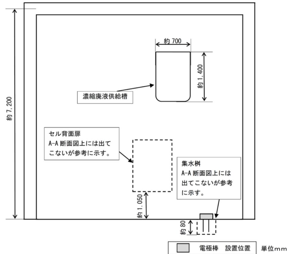
1階 固化セル A-A 断面図
