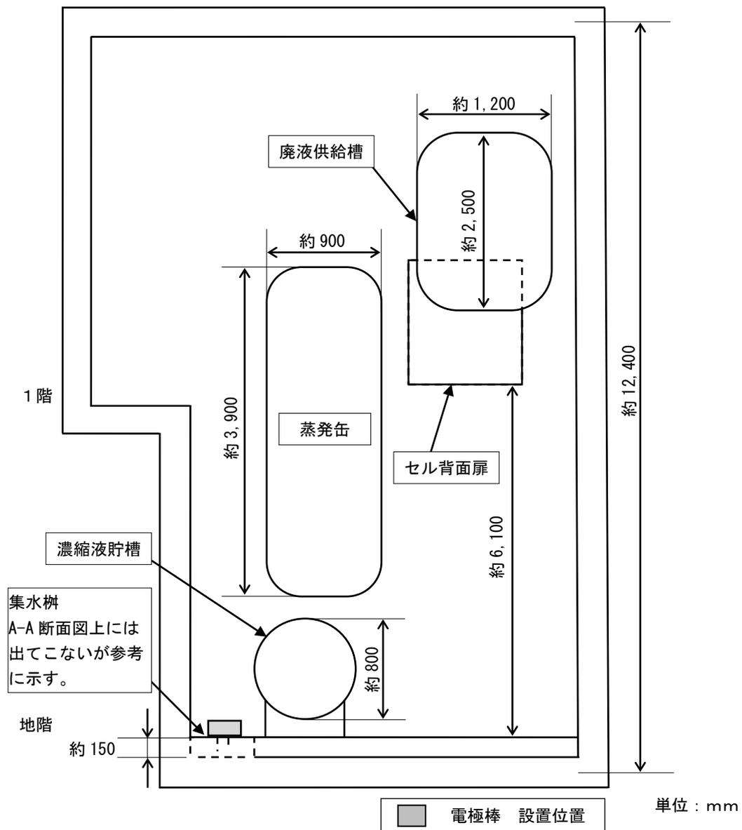
1階、地階 濃縮セル A-A断面図
