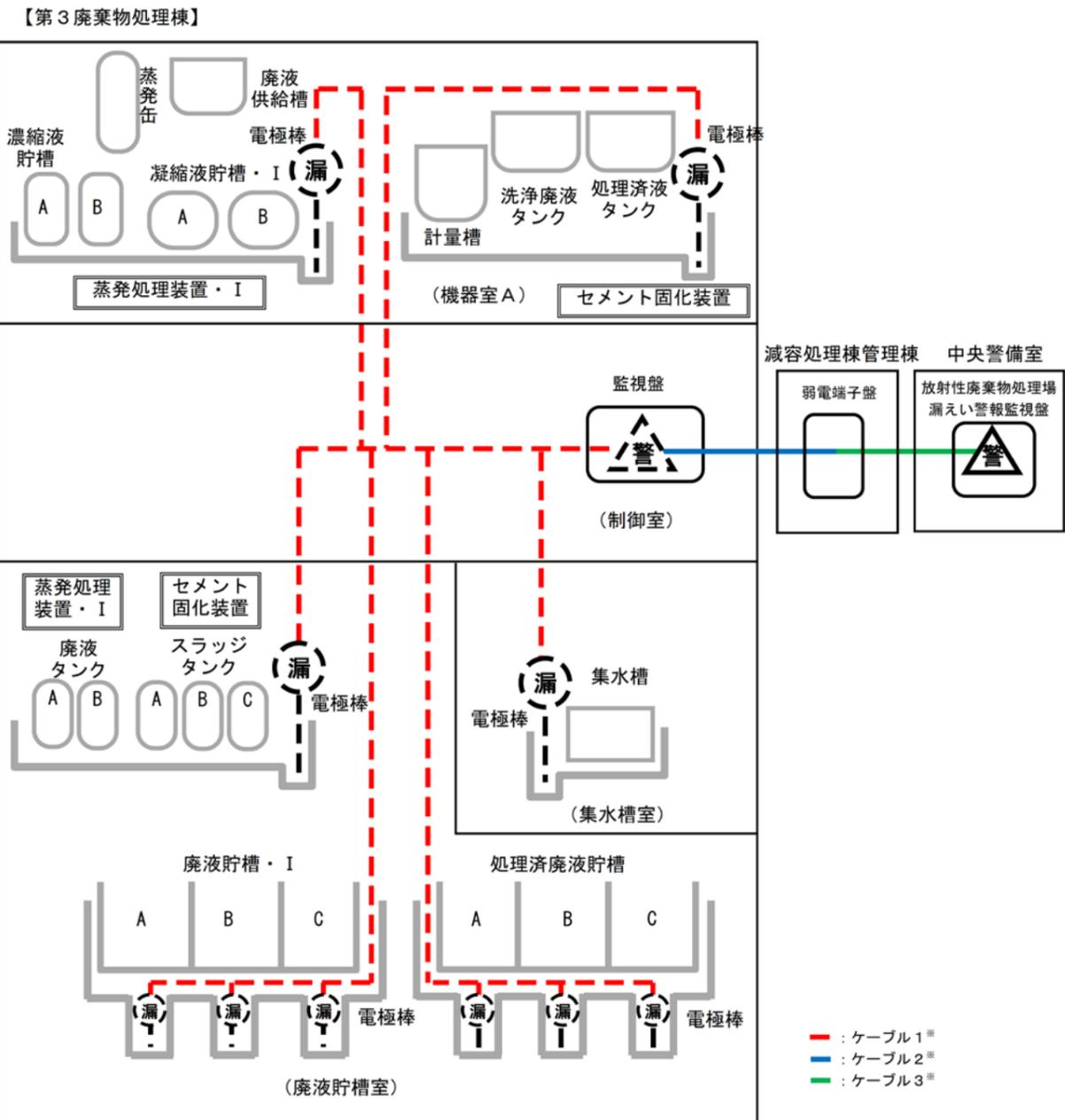
図-4.1 第3廃棄物処理棟の漏えい警報装置の系統図
