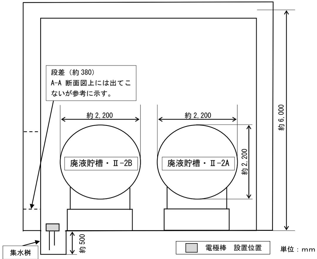
地階 処理前廃液貯槽室 A-A 断面図
