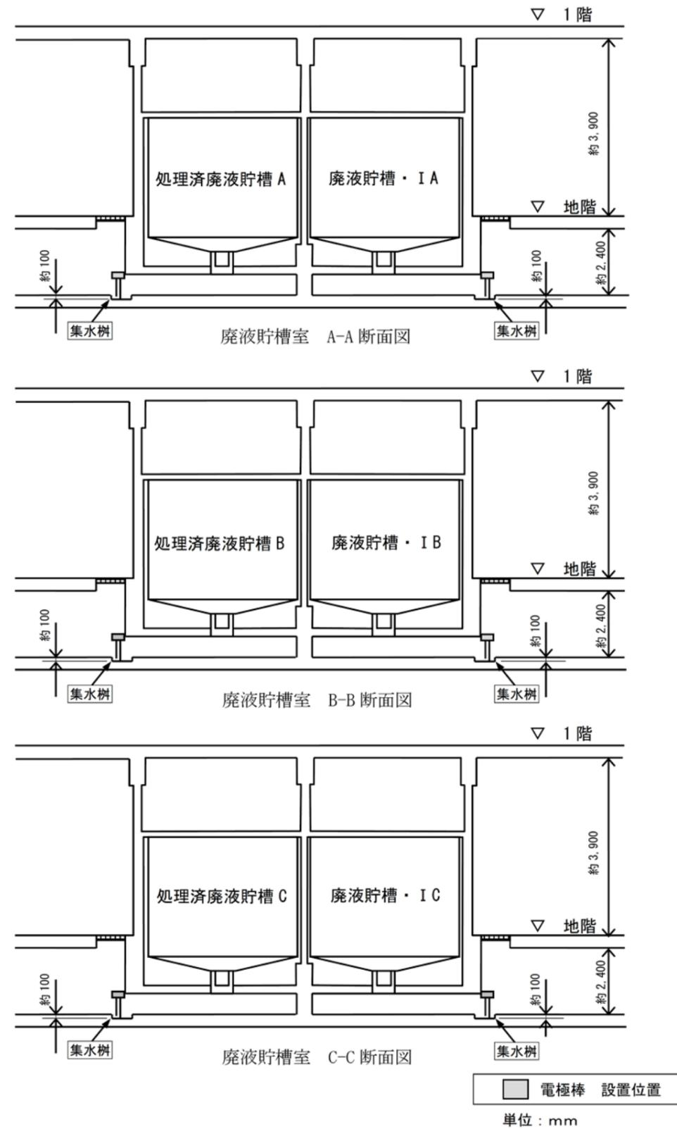
図-4.5 (2/2) 第3廃棄物処理棟の電極棒の配置図 (その4)
