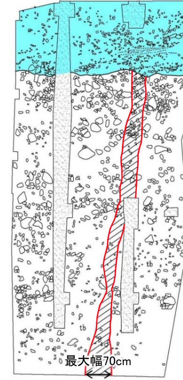
W 法面B地質スケッチ E
