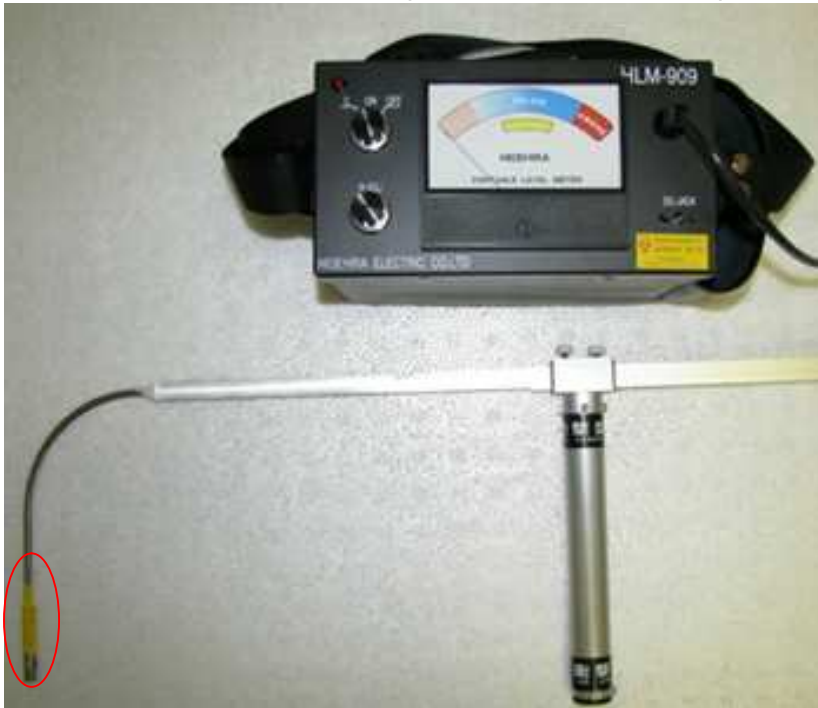
図 1.ポータブルレベルメータ は密封線源 (セシウム 137、3.7MBq) の内臓部分
