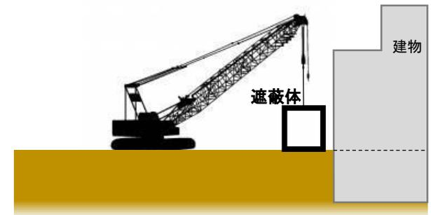
遮蔽体の設置による放射線対策例
