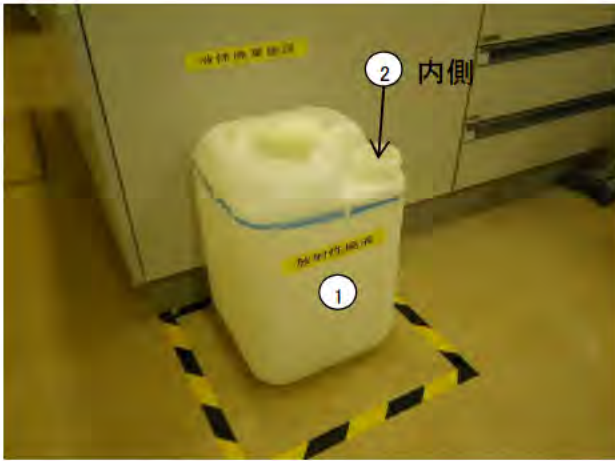
廃液貯留用ポリタンク No. 1・2
