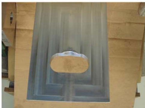
図 13 模擬ラグ A (スリット直交) 2 回目試験の試験後の供試体等の状況
