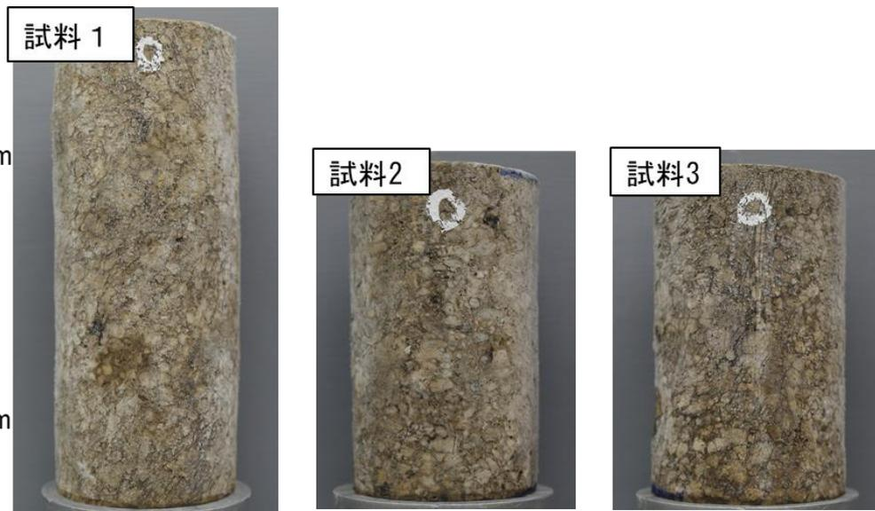
密度試験に用いた供試体の写真
