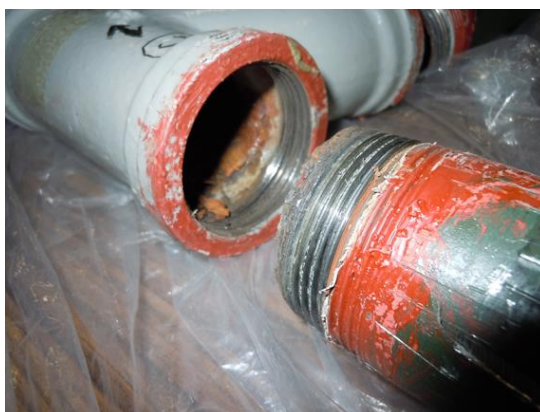
写真 12. ③部分_排水管の継手との接続部
