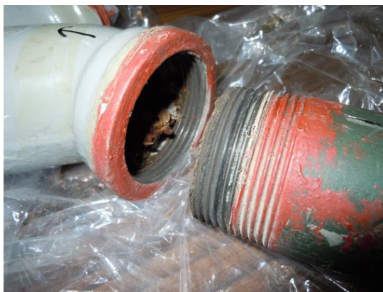
写真 18. ⑧部分_排水管の継手との接続部
