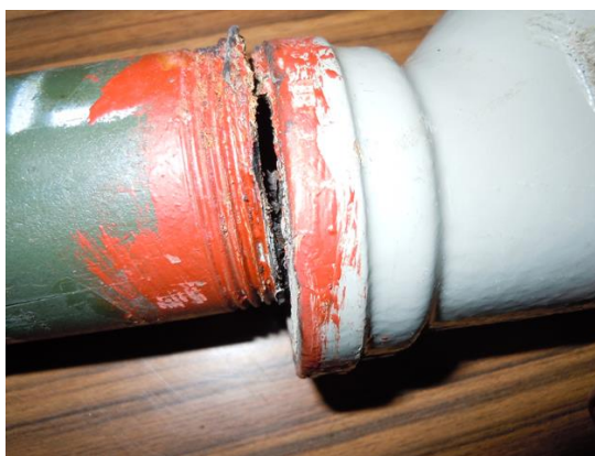
写真 12. ③部分_排水管の継手との接続部
